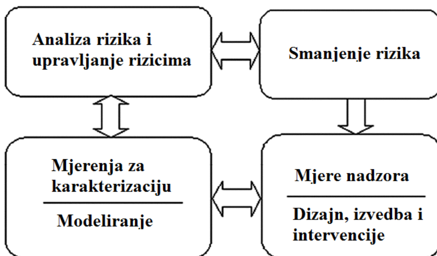
Slika 4-1. Opća metodologija za analizu integriteta bušotine (Manchao et al., 2011)
