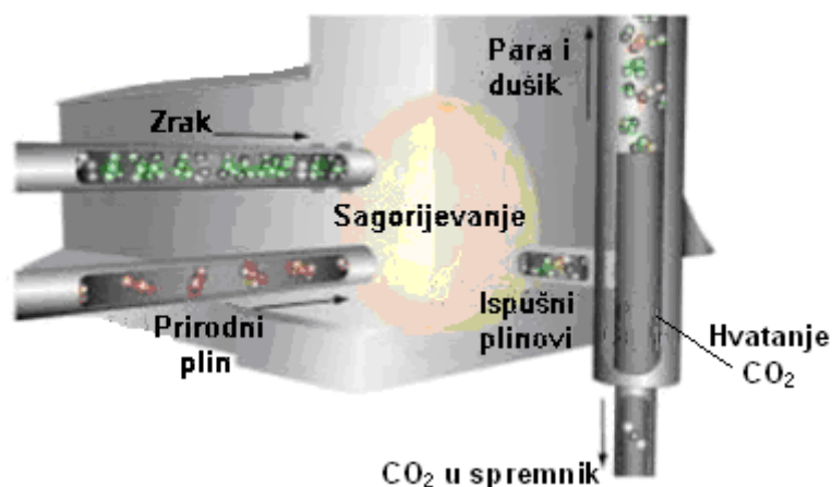
Slika 2-7. Izdvajanje CO 2 nakon izgaranja goriva (Hrnčević, 2008)
