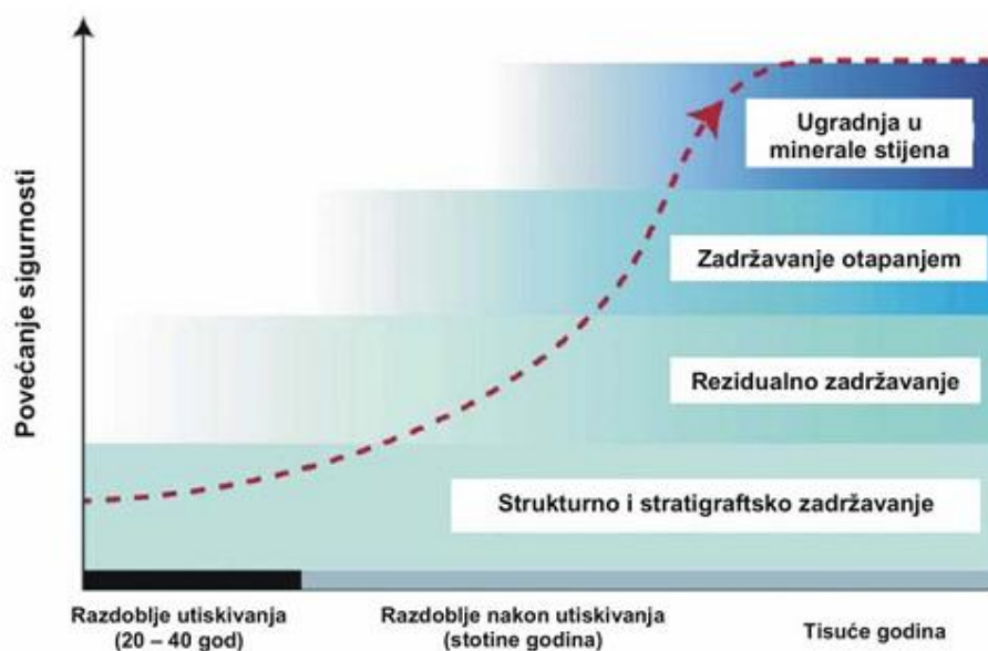
Slika 2-3. Mehanizmi uzamčivanja CO 2 (Hrnčević, 2008.)
