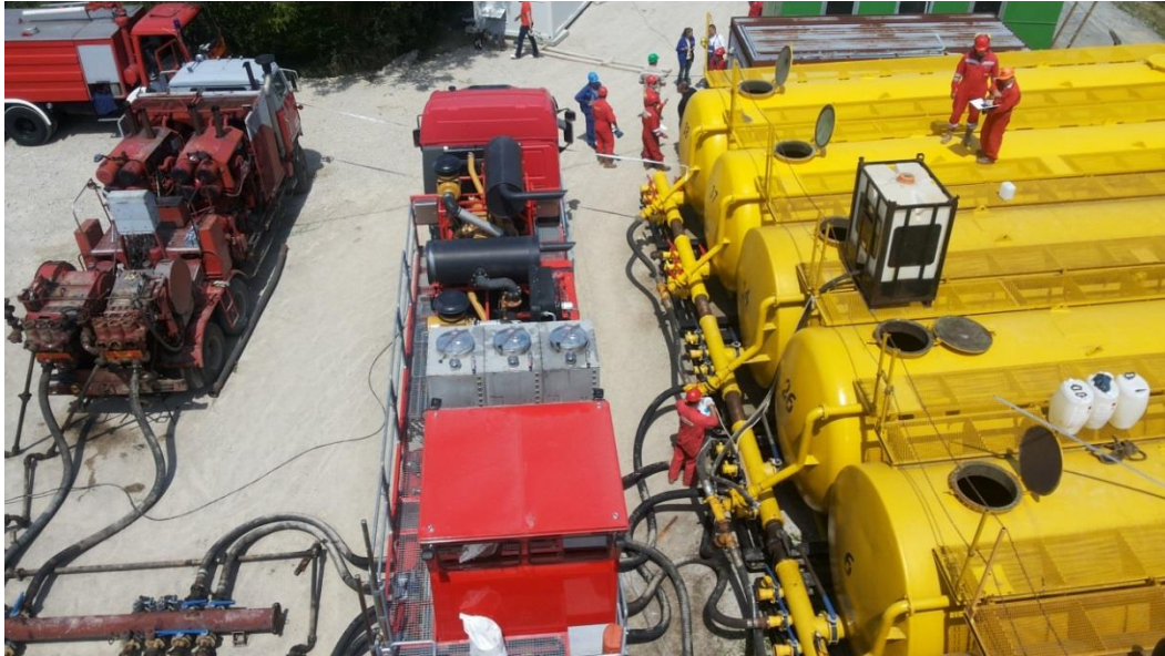
Slika 2.4. Mješalica za pripremu fluida za frakturiranje (Škrinjarić, 2015)
