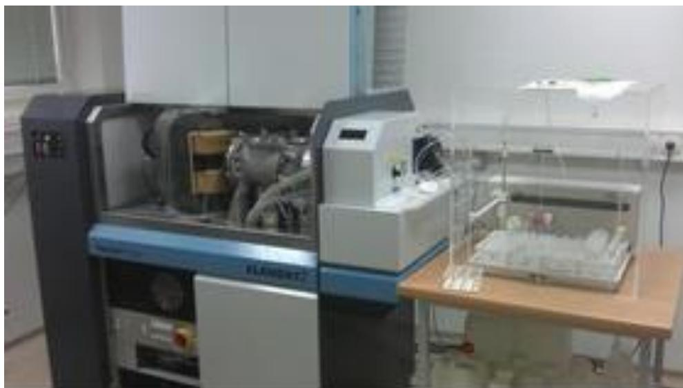
**Slika 3-4.** Maseni spektrometar visoke rezolucije s induktivno spregnutom plazmom u Institutu Ruđer Bošković, Zagreb ([www.irb.hr](http://www.irb.hr))
