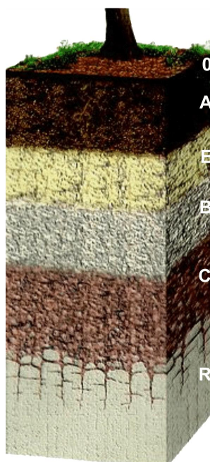
Slika 3.1. Pedološki profil (preuzeto s http://pedologija.com.hr/pedog_siste.htm , 19.04.2017)
