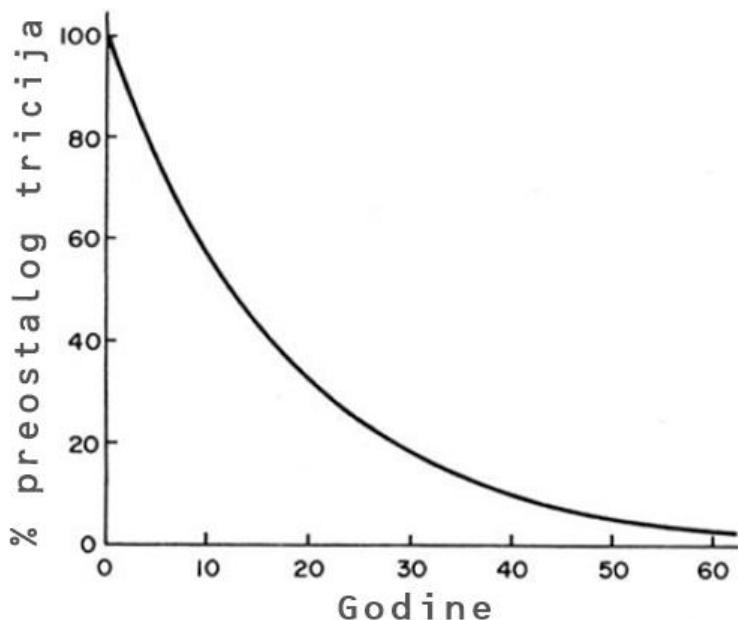
**Slika 6-1.** Krivulja radioaktivnog raspada tricija (modificirano prema Mazor, 2004)
