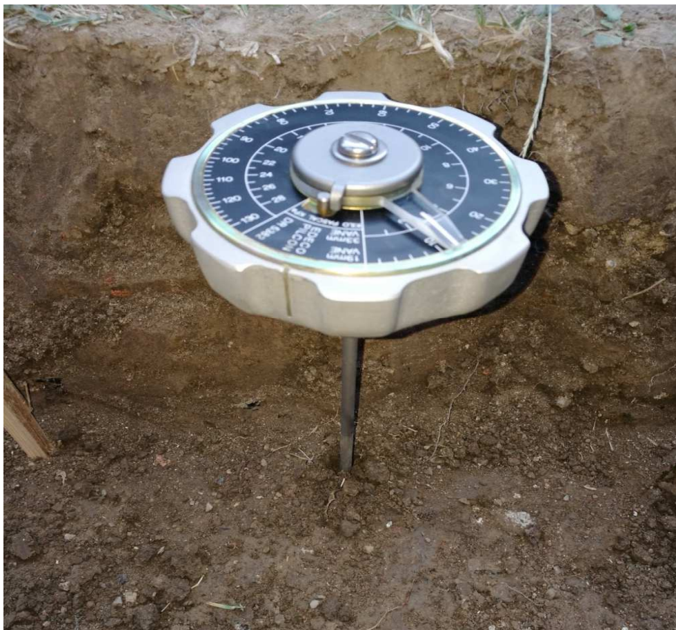
Slika 6-4 Krilna sonda utisnuta u tlo
