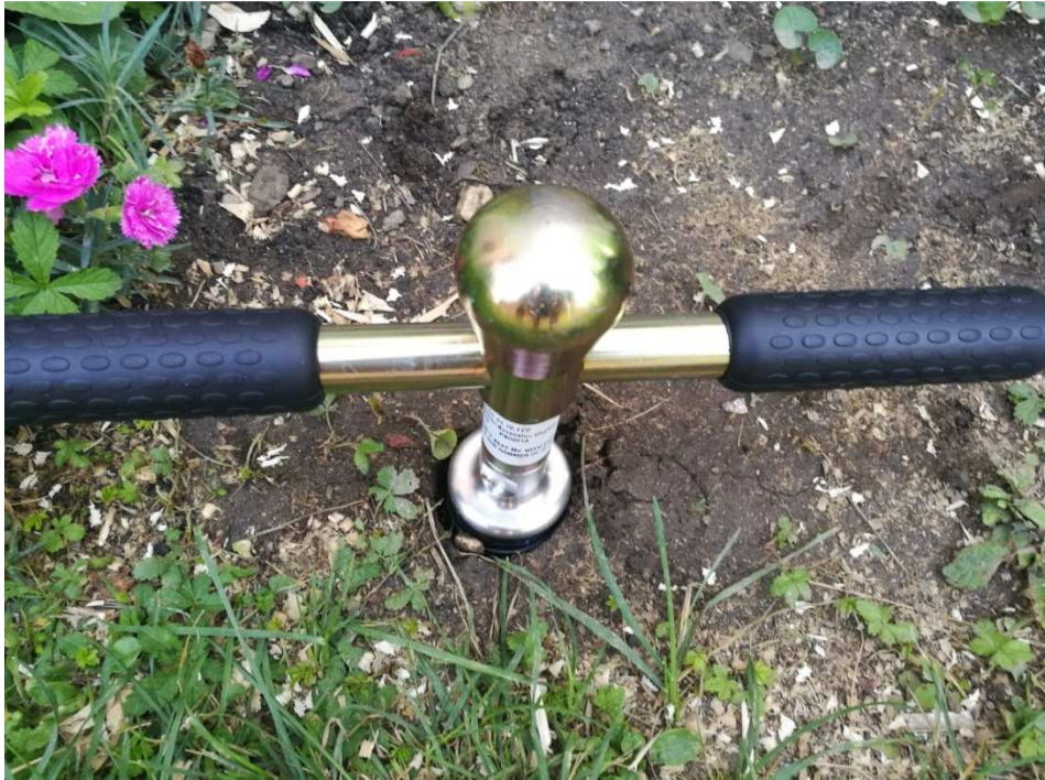
Slika 6-10 Uzorkivač utisnut u tlo
