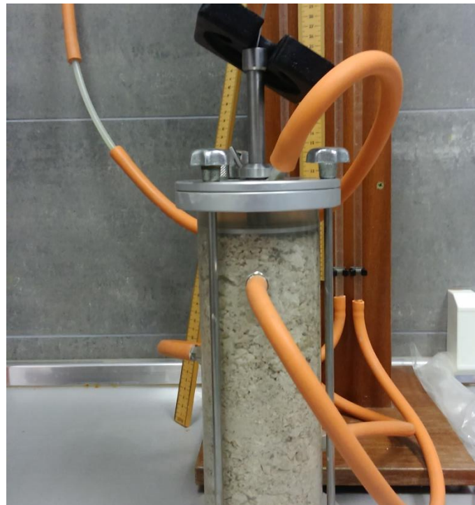
Slika 6.5. Permeametar pripremljen za testiranje
