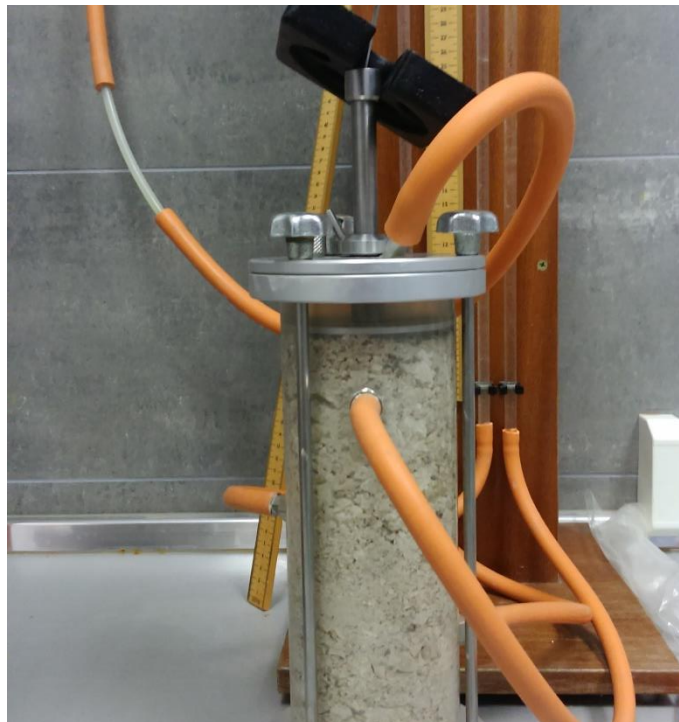
Slika 6.5. Permeametar pripremljen za testiranje
