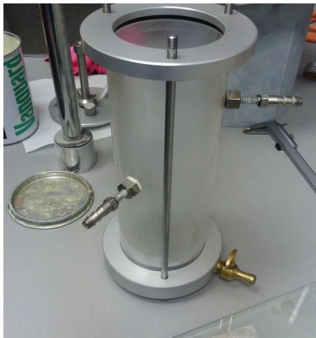
Slika 6.3. Permeametar prije ugradnje uzorka
