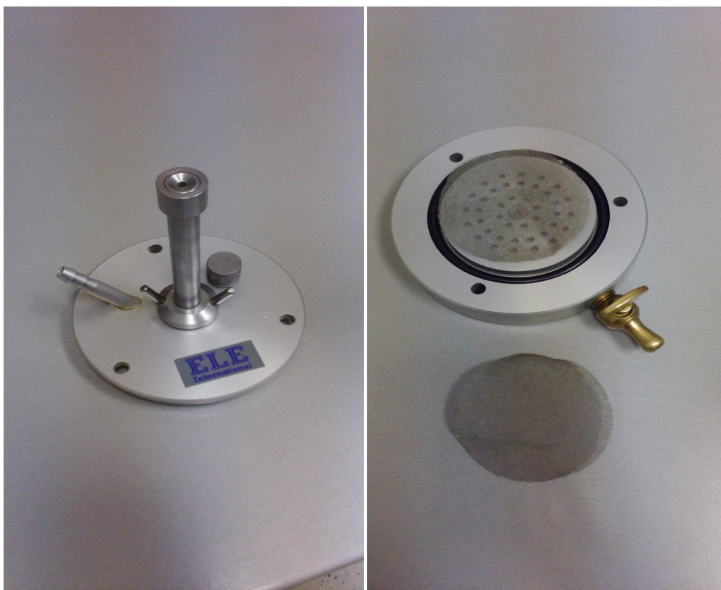
Slika 6.1. Slika a) gornja; Slika b) donja porozna ploča permeametra
