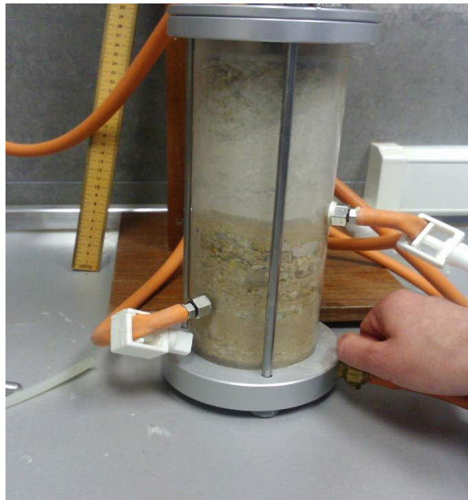
Slika 6.6. Saturacija uzorka u permeametri
