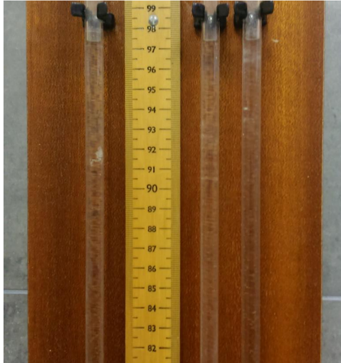
Slika 6.7. Početno stanje u manometarskim cjevčicama
