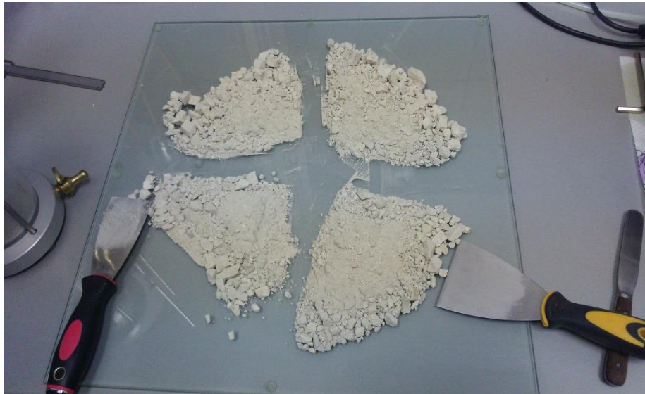
Slika 6.4. Priprema uzorka za ugradnju
