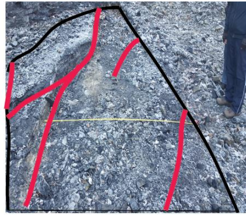
Slika 7.6a Gornja slojna ploha na površini Slika 7.6b. Označene pukotine i konture površine
