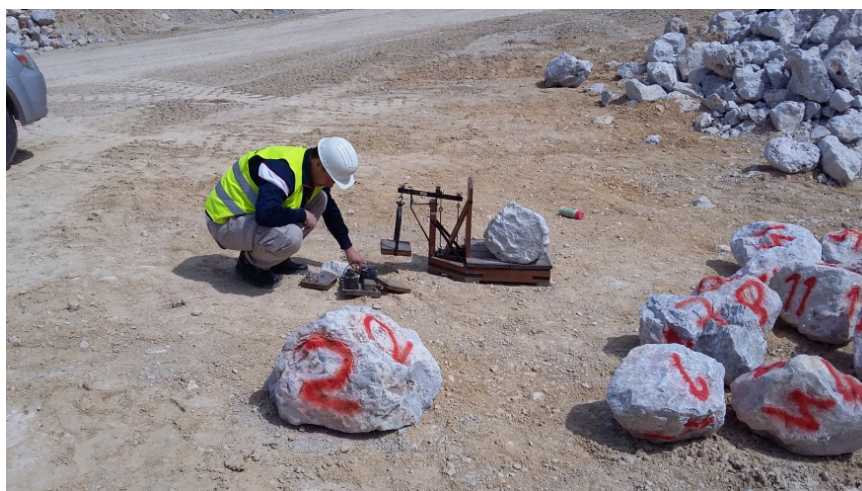
Slika 5-2. Vaganje i označavanje uzoraka na kamenolomu „Očura“
