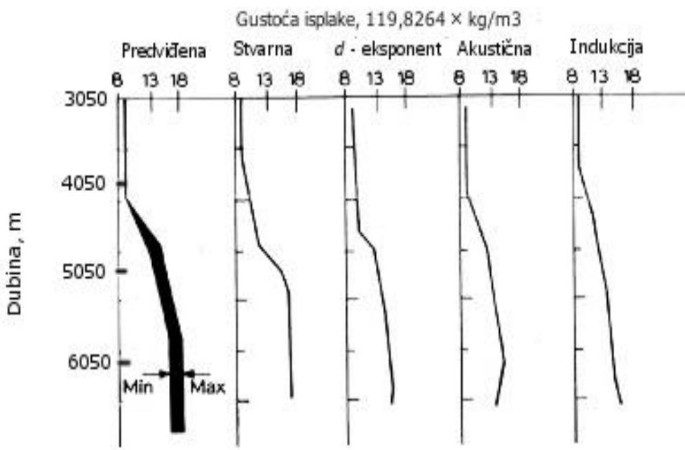
**Slika 3-4.** Usporedba podataka o slojnom tlaku te vrijednosti predviđene i stvarne gustoće isplake (Louden et al., 1971) (Courtesy of World Oil).
