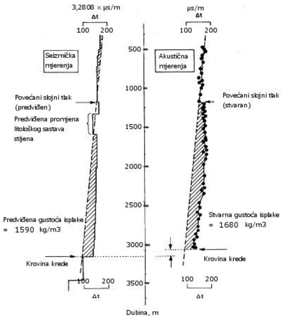
**Slika 3-3.** Usporedba predviđenog slojnog tlaka dobivenog seizmičkim mjerjenjima i stvarnog slojnog tlaka dobivenog zvučnom karotažom (Herring, 1973.) (Courtesy of Petroleum Engineer.)
