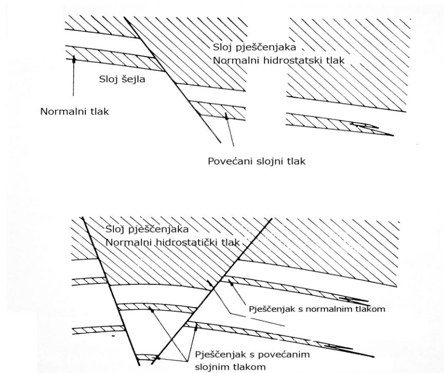
**Slika 2-2.** Utjecaj pojave rasjeda na nastajanje zona povećanog slojnog tlaka (Dickinson, 1953)
