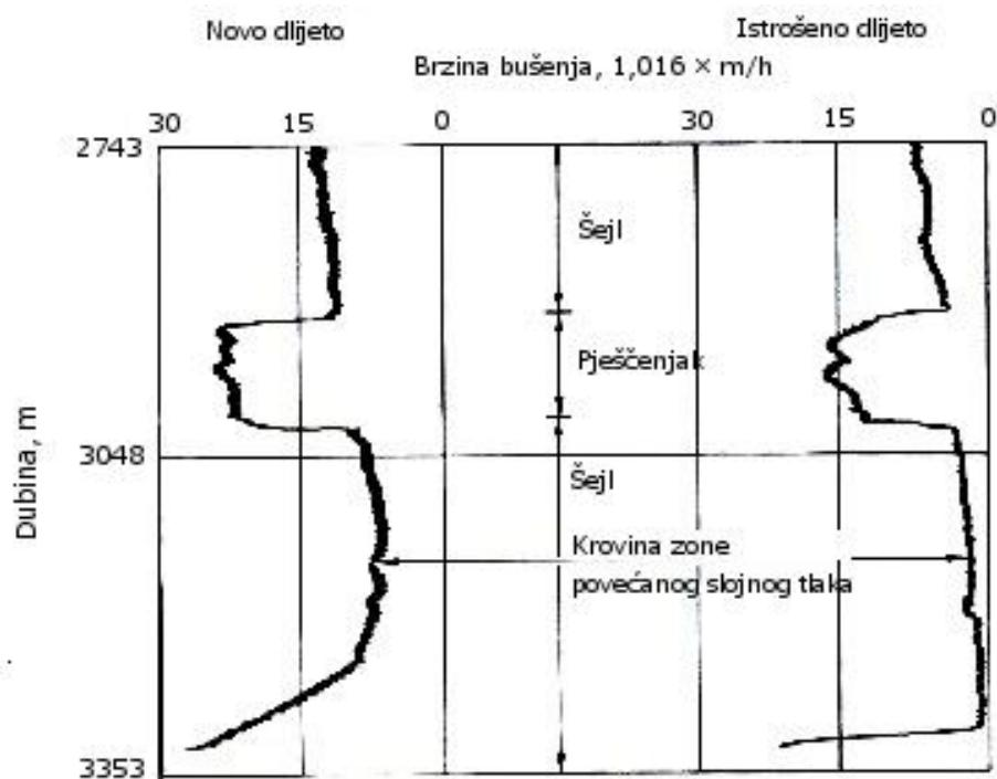
Slika 3-7. Utjecaj istrošenosti dlijeta na mehaničku brzinu bušenja (Matthews, 1969)
