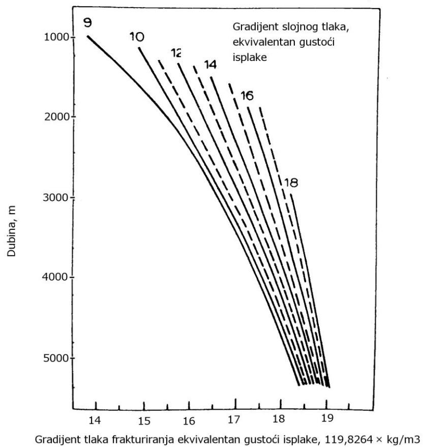
**Slika 4-3.** Grafički prikaz procijenjenih krivulja tlaka frakturiranja i slojnog tlaka dobivenih pomoću Eatoneve metode (Eaton, 1970).
