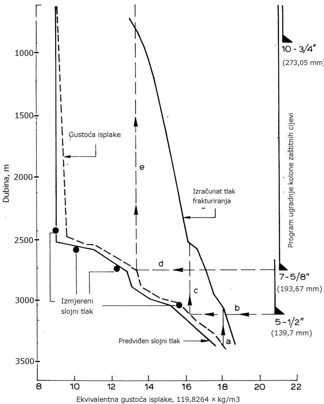
**Slika 4-4.** Program ugradnje kolone zaštitnih cijevi (Eaton, 1970)
