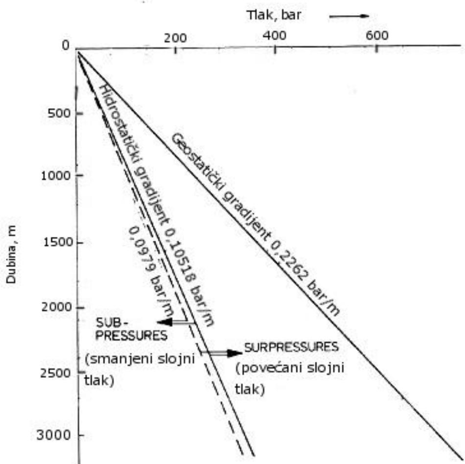
Slika 2-1. Promjena gradijenta geostatičkog i hidrostatickog tlaka s dubinom (Fertl, 1976)
