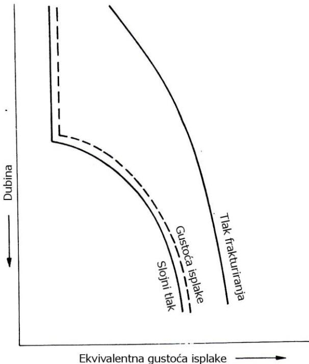
**Slika 4-1.** Ilustrativni prikaz promjene odnosa slojnog tlaka, tlaka frakturiranja i gustoće isplake s povećanjem dubine bušotine (Fertl, 1976)
