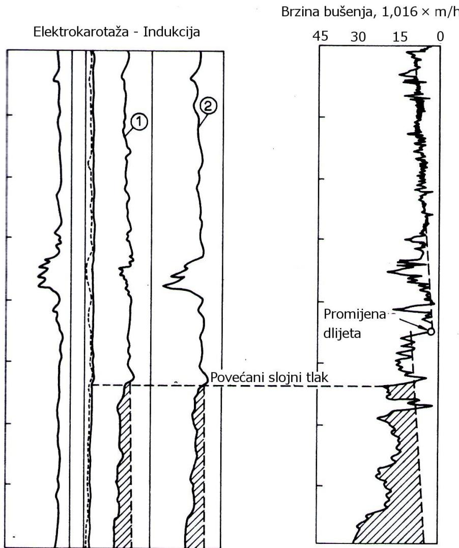
**Slika 3-6.** Korelacija mehaničke brzine bušenja i rezultata elektrokrotažnih ispitivanja (Jorden i Shirley, 1966)
