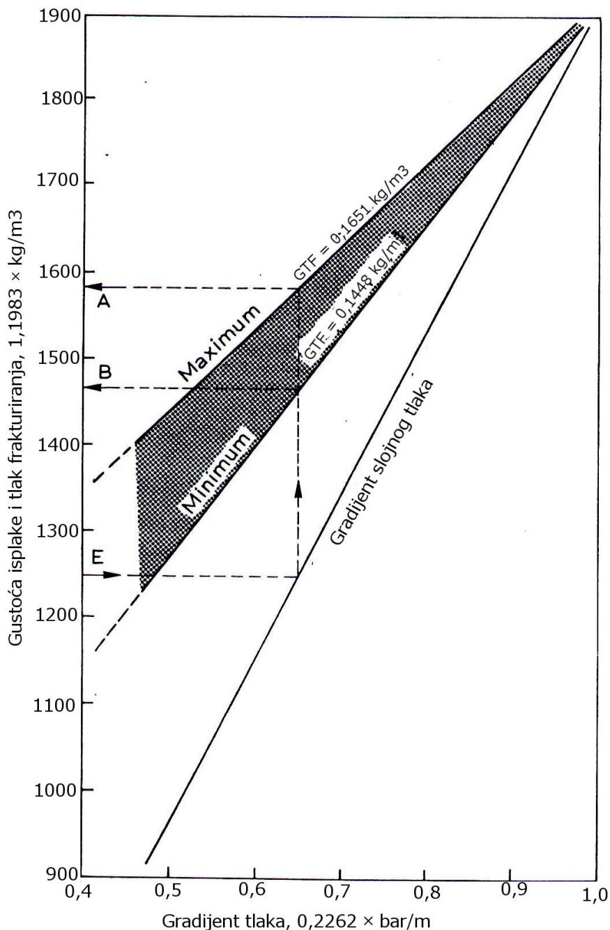
**Slika 4-2.** Promjena minimalnog i maksimalnog gradijenta tlaka frakturniranja s dubinom (Hubbert i Willis, 1957)
