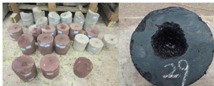
Slika 5-9. Uzorci mekog pješčenjaka i ugljena korišteni u opisanom ispitivanju (Bin et al., 2016)
