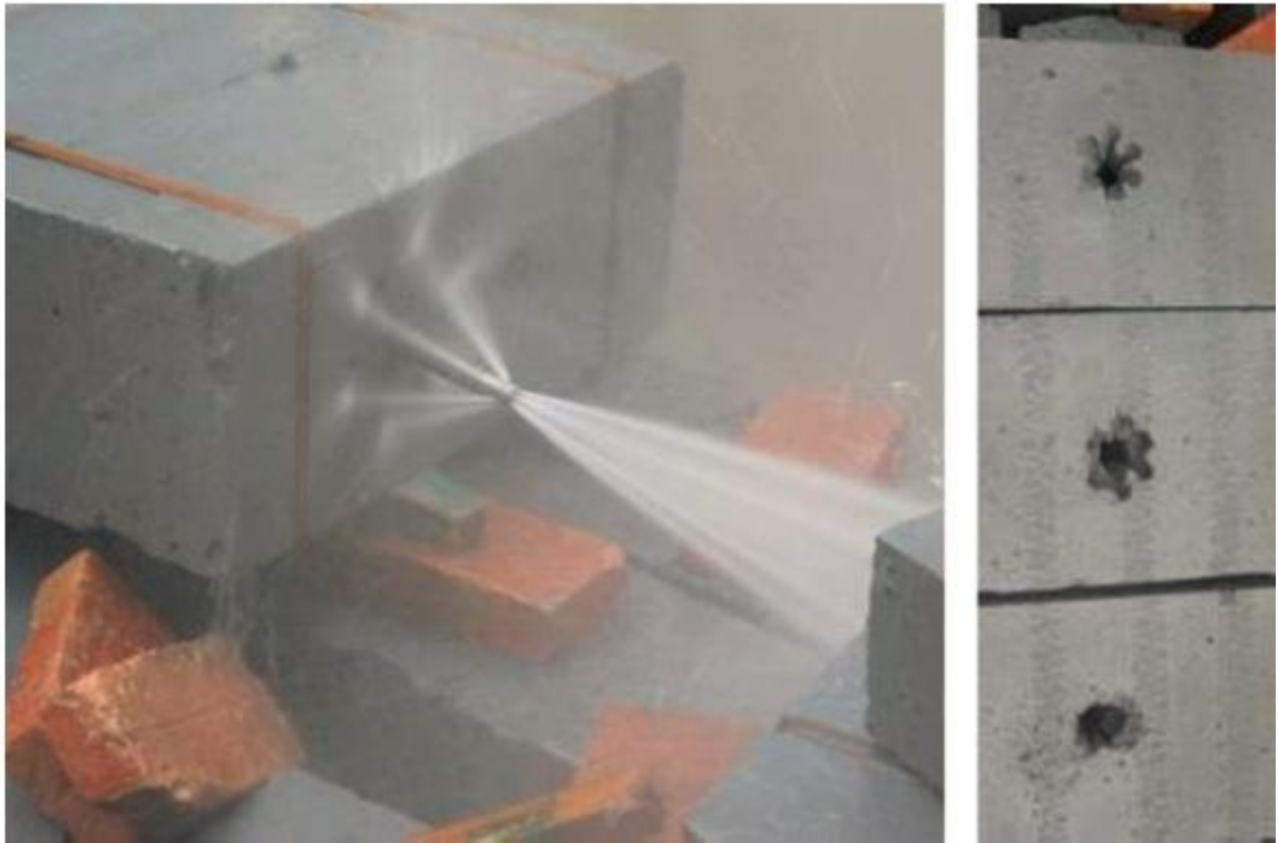
Slika 2-3. Razrušavanje stijena mlazom fluida (Bin et al., 2016)
