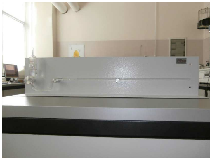
Slika 7-3 Uređaj za određivanje sposobnosti upijanja vode
