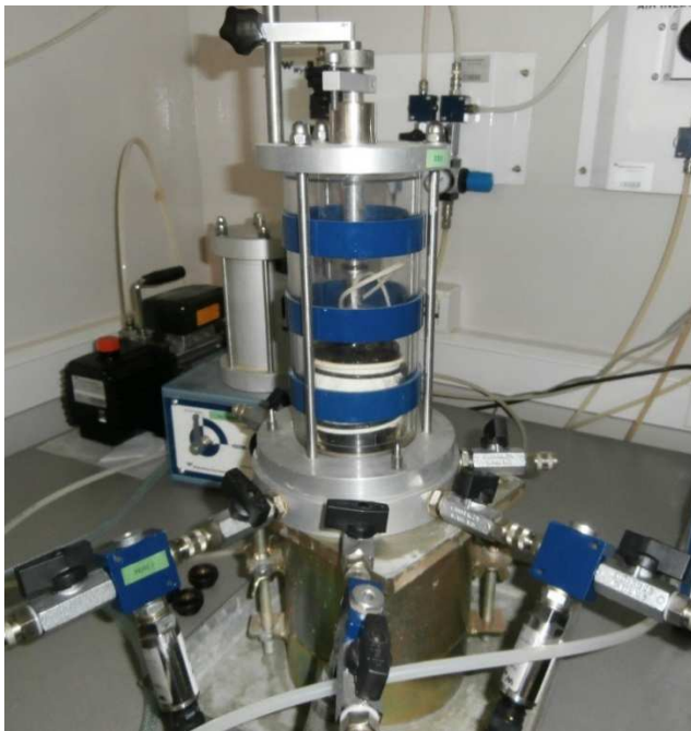
Slika 7-6 Ispitivanje koeficijenta propusnosti u troosnom uređaju
