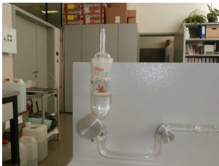
Slika 7-4 Uzorak tla u obliku stošca u uređaju za određivanje sposobnosti upijanja vode
