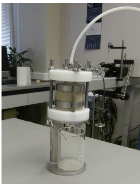
Slika 7-5 Uređaj za određivanje indeksa gubitka fluida
