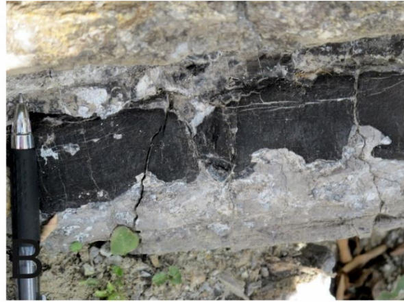
Slika 30. Facijes silicificiranih karbonata. A) Mikrofotografija potpuno silicificiranog makrokristalastog dolomita. Uzorak Sinj-3. B) Makroskopski uzorak silicificiranog karbonata. Silicifikacija se pojavljuje u nepravilnim lećama, nodulama ili rijetko proslojcima.
