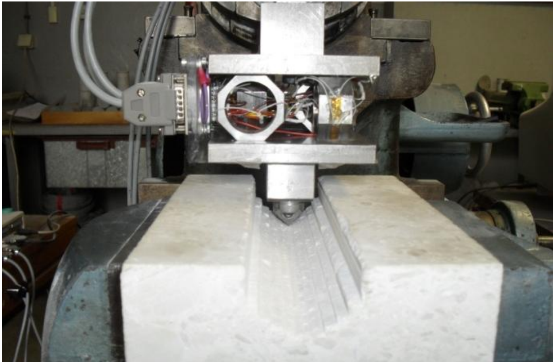
Slika 6.19. Simulacija procesa rezanja.
