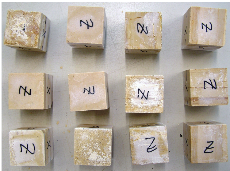
Sl.5.64. Eflorescencija soli na donjoj bazi uzoraka mikritnog litotipa.
