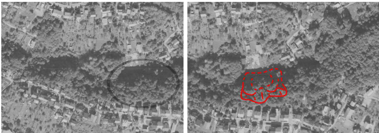
Slika 102 Stereogram klizišta broj 981091 na padini sjeverno od ulice Gospočak prema stereomodelu iz 1998. godine s označenom širom lokacijom klizišta (elipsa na lijevoj slici) i vidljivim elementima klizišta (crvene linije na desnoj slici)
