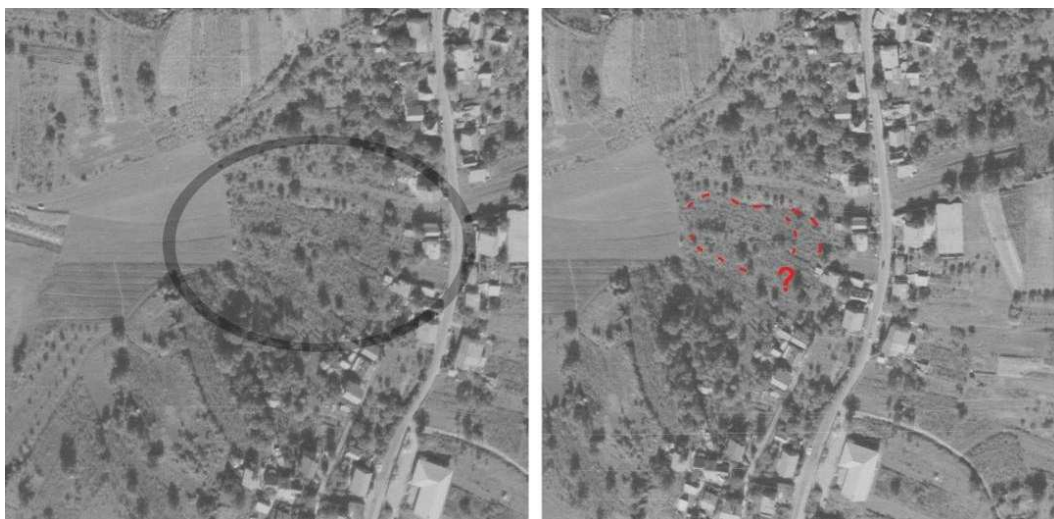
Slika 96 Stereogram klizišta broj 980634 na padini zapadno od ulice Lukšić prema stereomodelu iz 1998. godine s označenom širom lokacijom klizišta (elipsa na lijevoj slici) i vidljivim elementima klizišta (crvene linije na desnoj slici)
