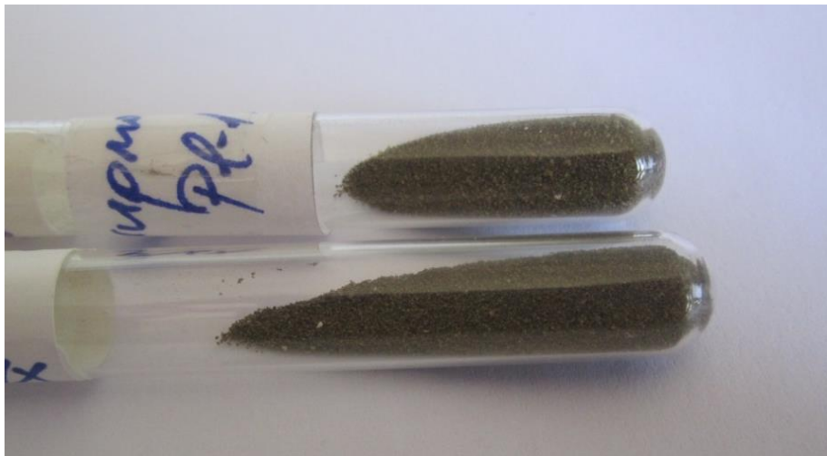
Sl. 3.9. Uzorak podijeljen na dvije faze nakon separacije na magnetnom separatoru.
