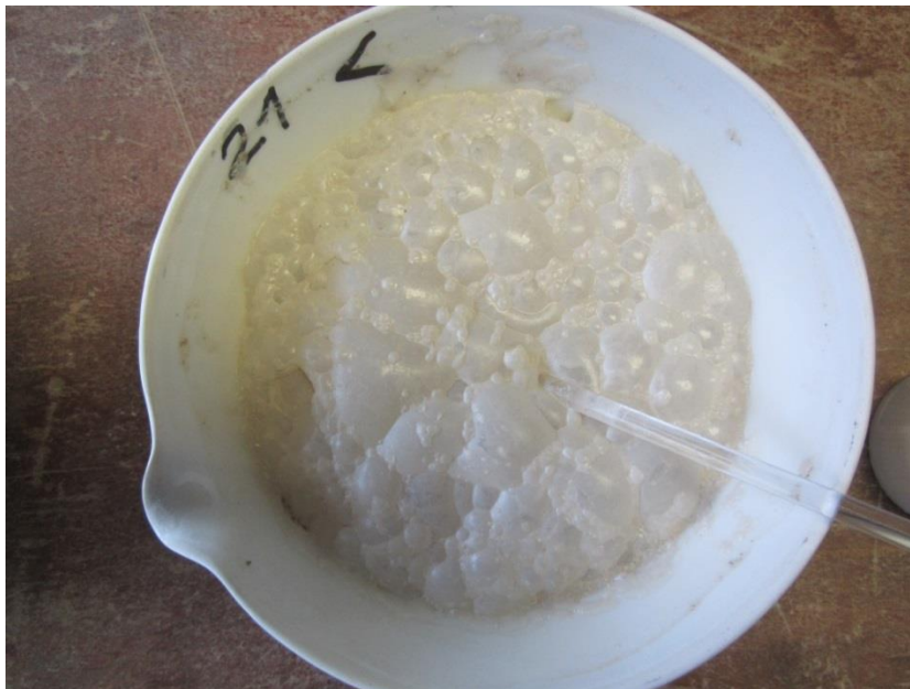
Sl. 3.6. Reakcija 10% octene kiseline s usitnjenim uzorkom kalciferskog vapnenca.
