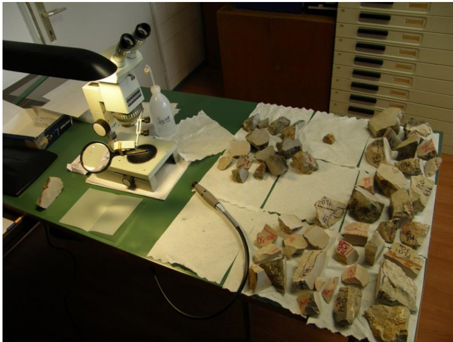
Sl. 3.4. Priprema uzoraka za analizu stabilnih izotopa (uzorci su izrezani, polirani, te isprani u destiliranoj vodi).
