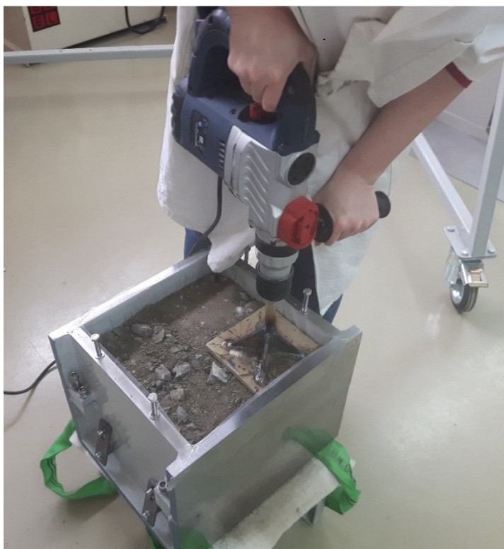
Slika 4-4 Ugradnja uzorka u kutiju
