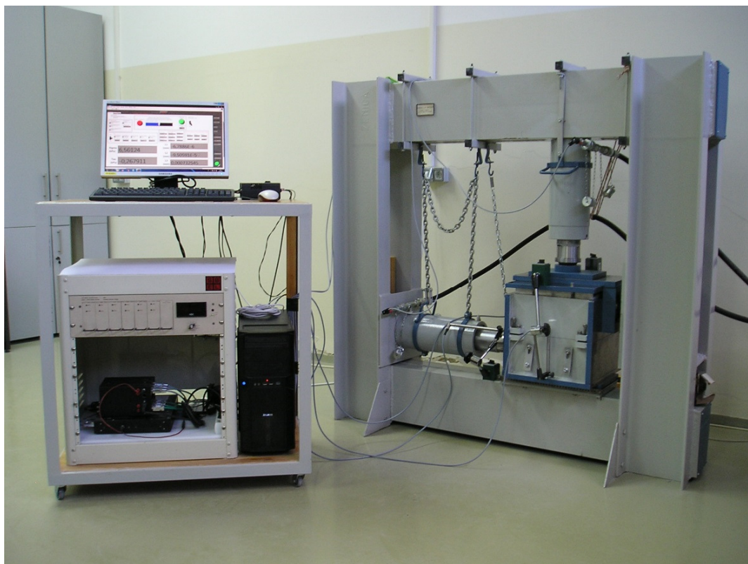
Slika 4-1 Veliki uređaj za izravni posmik
