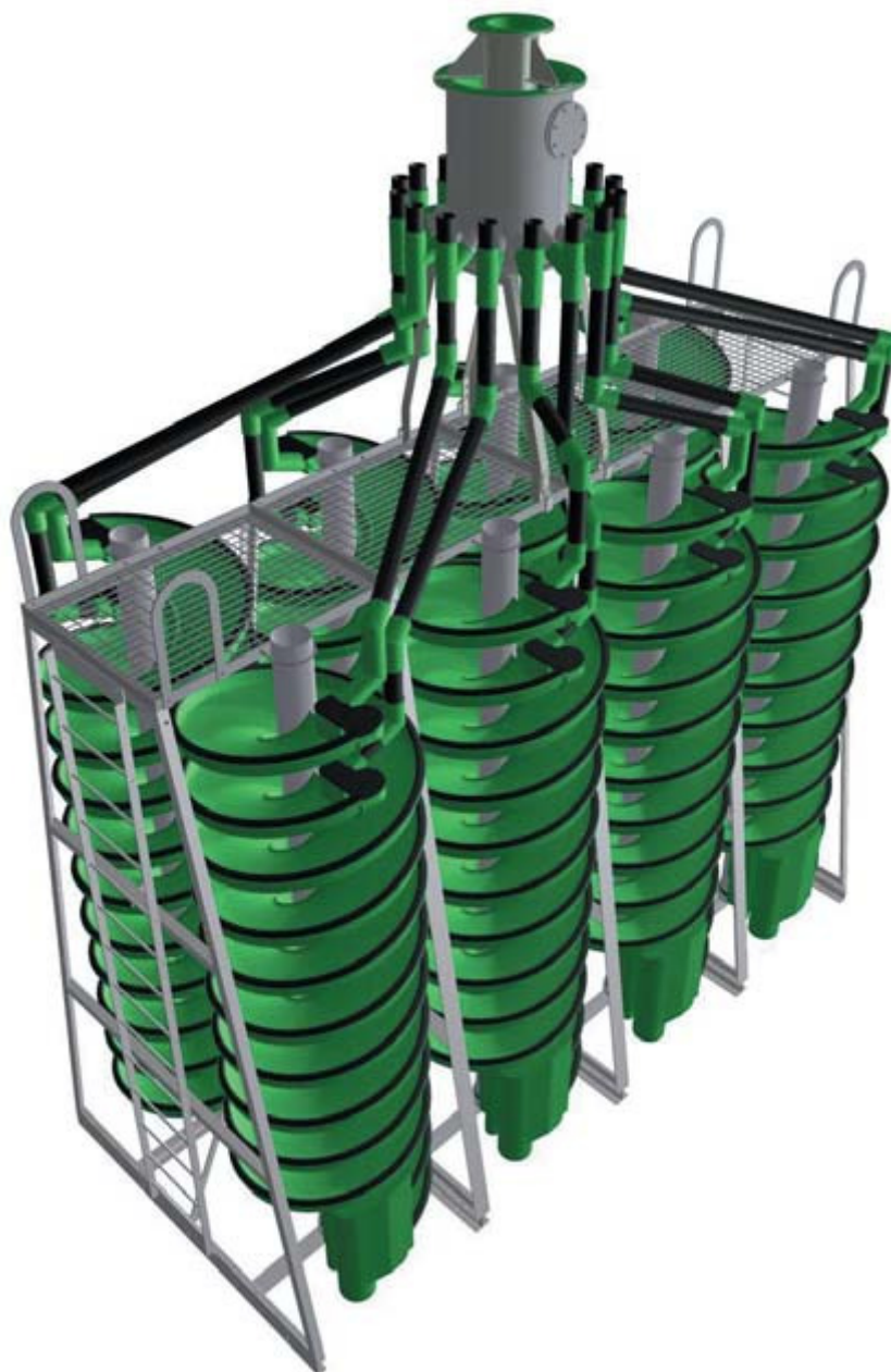
Slika 7-11. Spiralni separator MULTOTEC HX5 (Multotec, 2014)
