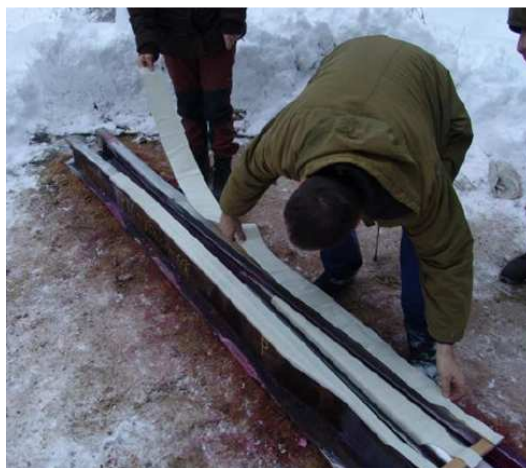
Slika 3-14. Postavljanje eksploziva na obradak (Havliček & Nesvadba 2011)
