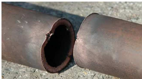
Slika 4-8. Savitljivi linijski kumulativni rezač postavljen na cijev i prerezana cijev
