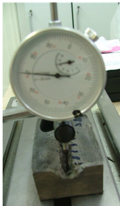
a) pozicioniranje mikroure prije početka mjerenja b) mjerenje dubine reza
