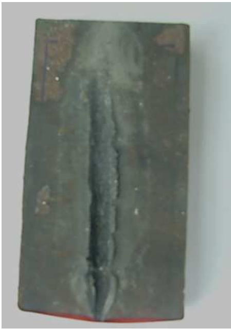
Rez u čeličnoj meti
