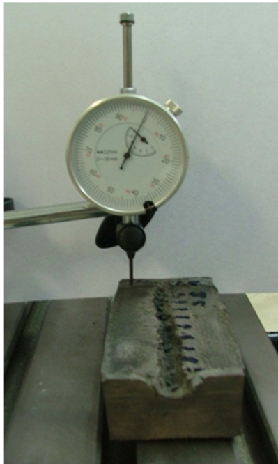
a) pozicioniranje mikroure prije početka mjerenja b) mjerenje dubine reza
