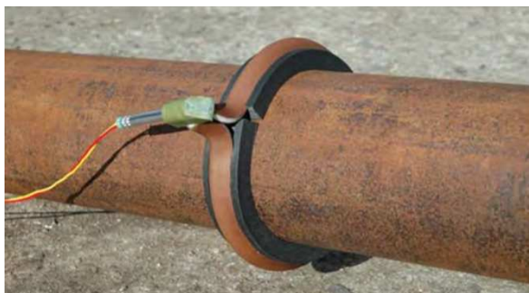
Slika 4-8. Savitljivi linijski kumulativni rezač postavljen na cijev i prerezana cijev
