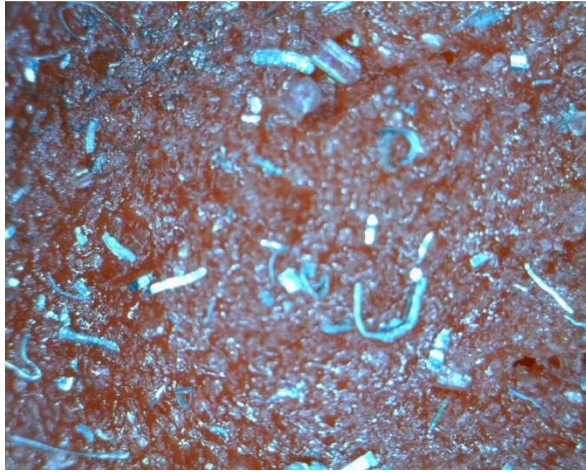
Struktura eksploziva s Al prahom
