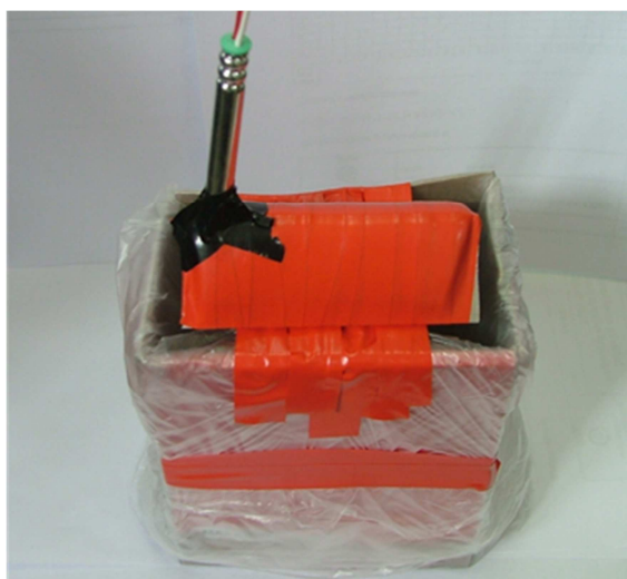
Slika 6-20. Ispitivanje oblika i stanja obloge –postav II u vodi
