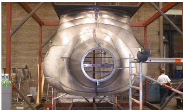
Slika 3-6. Rolls-Royce MT30 ispušni kolektor ( http://www.3dmetalforming.com )
