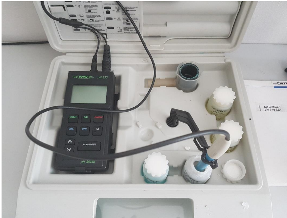
Slika 5-12. Pribor za mjerenje pH (WTW model pH 330)
