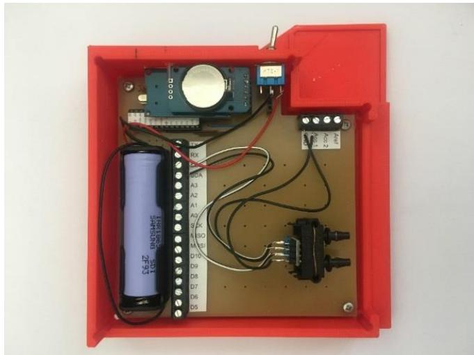
Slika 5-8. Digitalni manometar u samogradnji, Rudarsko-geološko-naftni fakultet.
