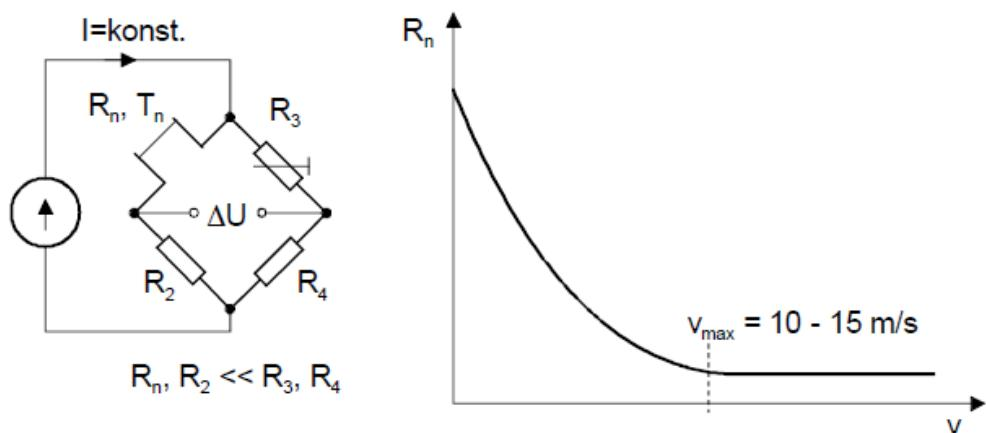
**Slika 2-6.** Wheatstone-ov most kod anemometra s žarnom žicom čiji se rad zasniva na konstantnoj struji ( $U$  – napon) desno i krivulja ovisnosti električnog otpora ( $R$ ) o brzini strujanja zraka ( $v$ ) lijevo (FER, 2017).
