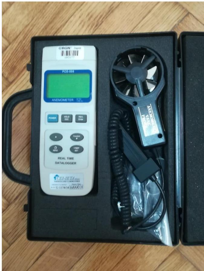
Slika 5-3. Digitalni krilni anemometar PCE – 008, Rudarsko-geološko-naftni fakultet.
