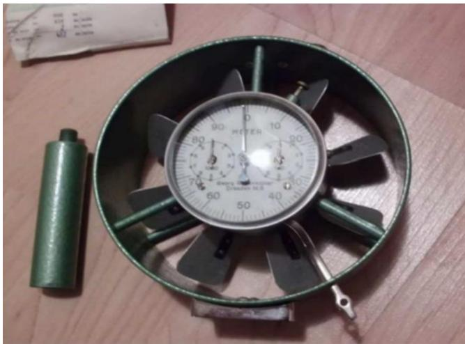
Slika 2-1. Analogni krilni anemometar (Klanfar, 2017).
