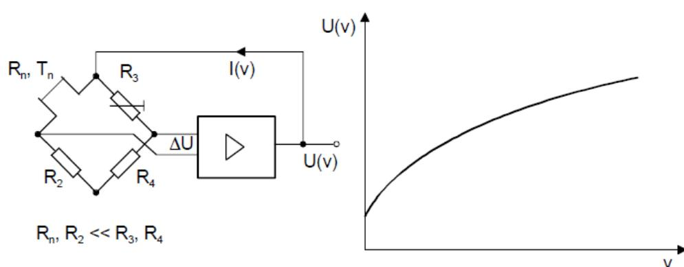
**Slika 2-5.** Wheatstone-ov most kod anemometra s žarnom žicom čiji se rad zasniva na konstantnoj temperaturi ( $R$  – električni otpor) desno i krivulja ovisnosti napona ( $U$ ) o brzini strujanja zraka ( $v$ ) lijevo (FER, 2017).
