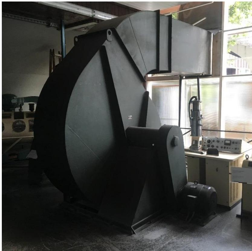
**Slika 5-14.** Centrifugalni ventilator.
