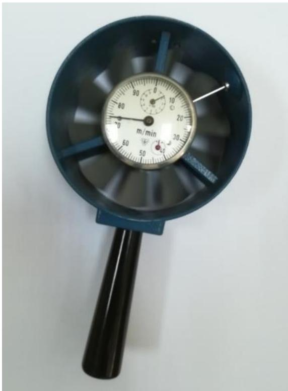
Slika 5-4. Analogni krilni anemometar, Rudarsko-geološko-naftni fakultet.
