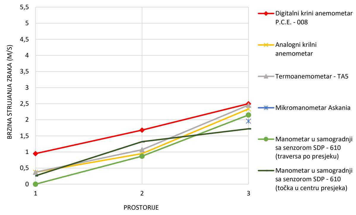
Slika 7-3. Dijagram odnosa brzine strujanja zraka kroz prostorije različitih oblika i veličina poprečnih presjeka.
