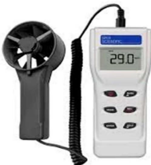
Slika 2-2. Digitalni krilni anemometar (Klanfar, 2017).
