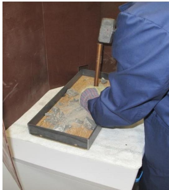
Slika 3-3. Usitnjavanje uzorka čekićem (foto Gulam).
