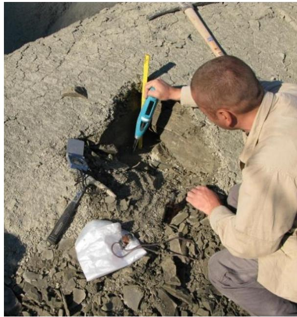
Slika 3-7. Ispitivanje Schmidtovim čekićem na terenu (Gulam, 2012).
