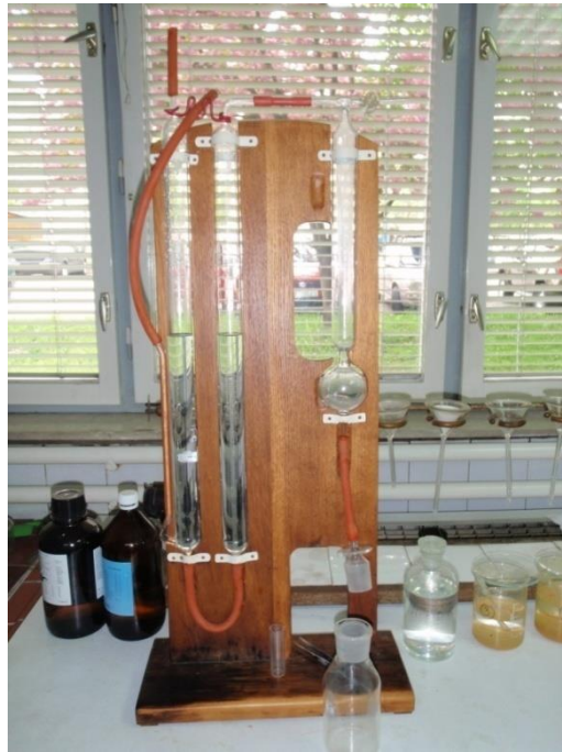
Slika 3-2. Collinsov kalcimetar (foto Gulam).
