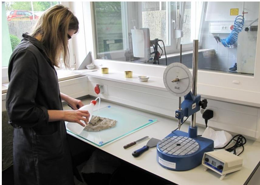
Slika 3-4. Pripremanje uzorka za određivanje granice tečenja uzorka laporu konusnim penetrometrom (foto Gulam).
