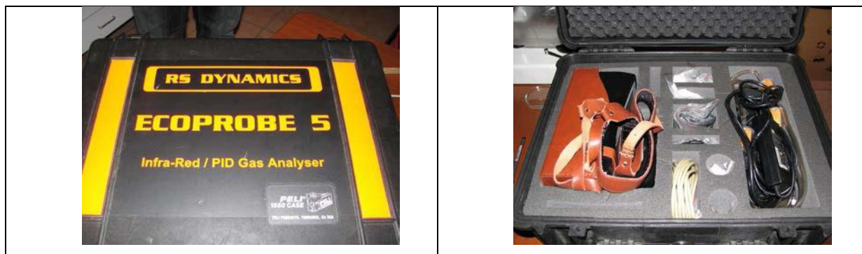
Slika 9-15. Uređaj za terensko mjerenje plinova
