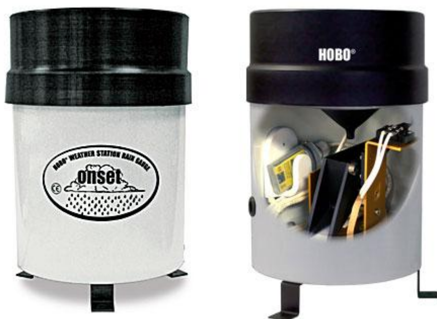
Slika 5.5. Kišomjer RG3-M proizvođača Hobo
