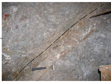
Brečirani dolomit, stariji rasjed, desni bok, 27-30 m
