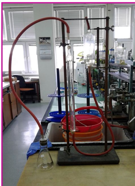
Slika 3-7. Scheibler-ov kalcimetar (foto: Trebeš, 2016)
