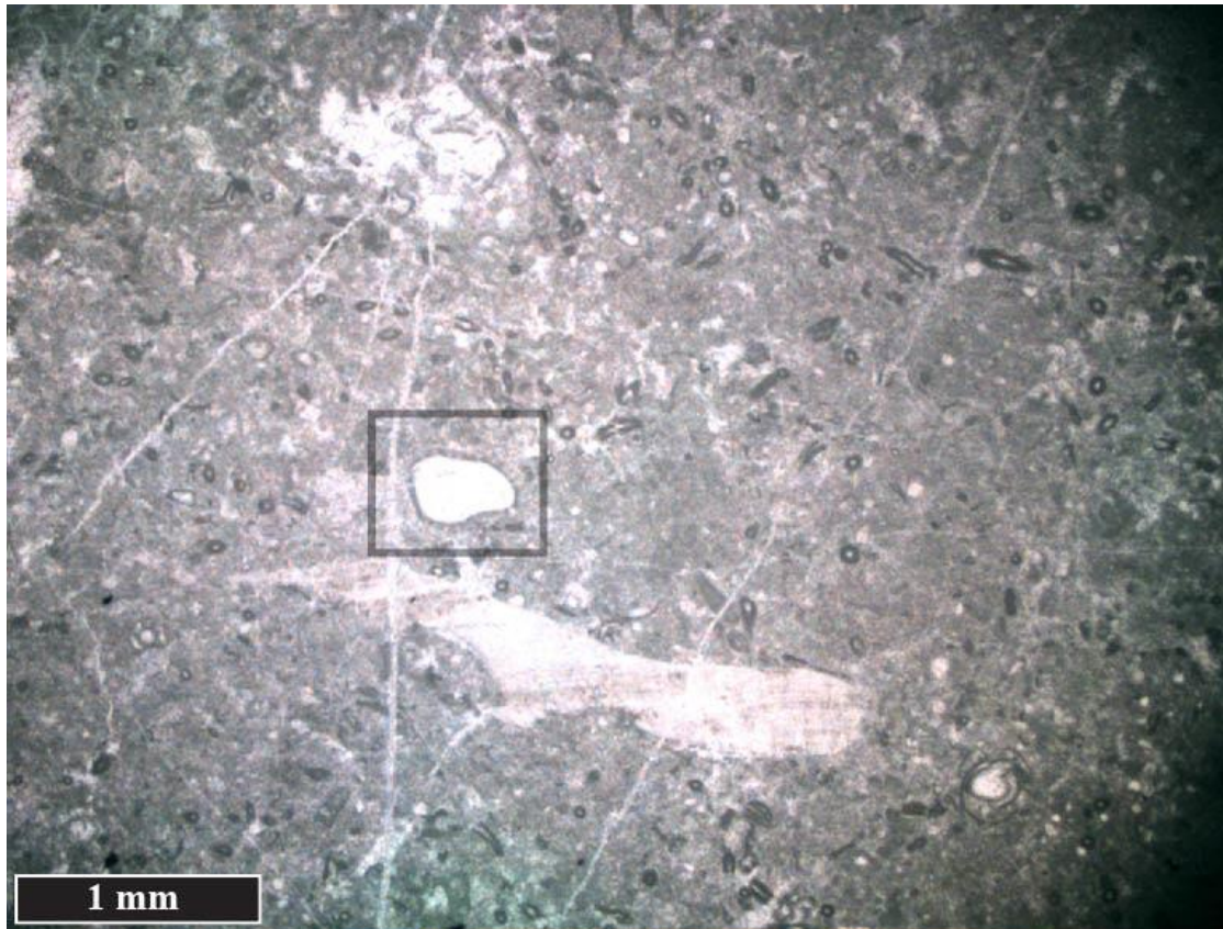
Slika 7-10. Mikrofotografija uzorka vapnenca TR-8. Karakteriziran je cijanobakterijama vrste Decastronema(Aeolisaccus) kotori (RADOIČIĆ), sitni fosili kružnih i izduženih oblika, ljušturama školjkaša i fragmentima alge Thaumotoporella parvovesiculifera (RAINERI) vidljivim u tamno uokvirenom području.
