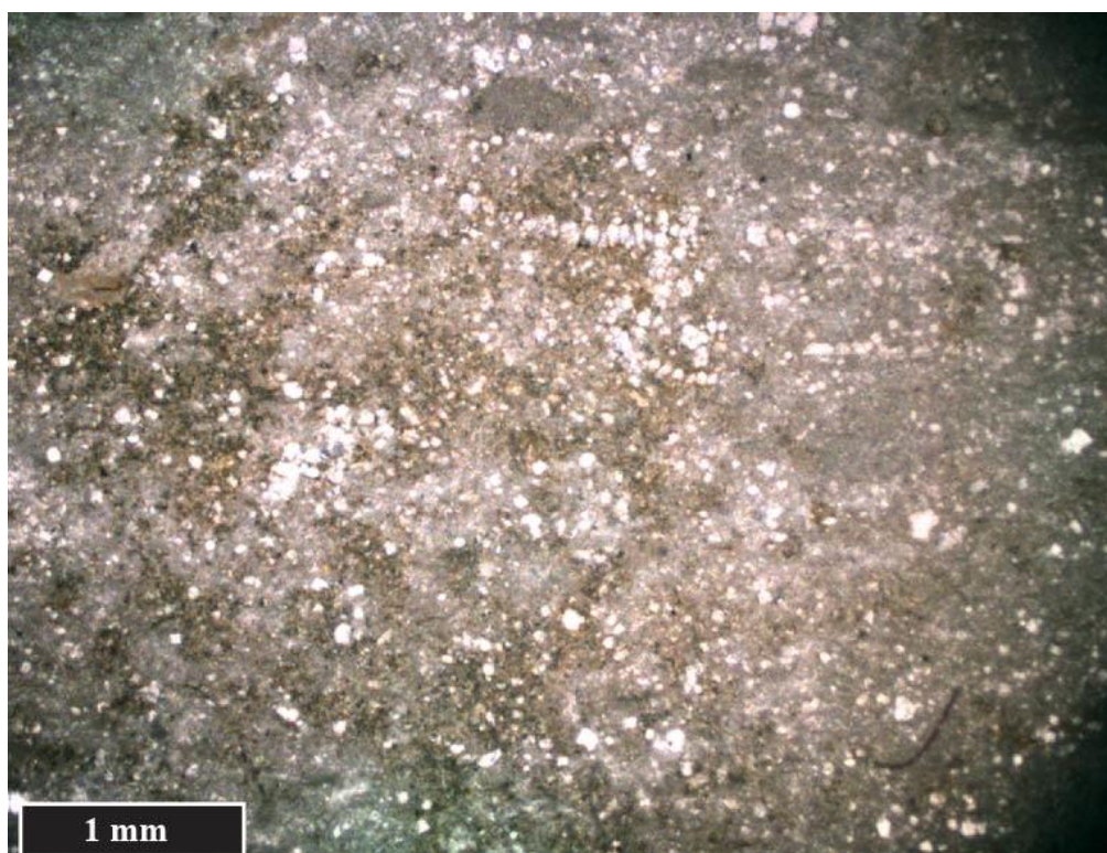
Slika 7-1. Mikrofotografija uzorka lapora TR-1 (N). Kalcit je predstavljen bijelo obojenim zrnima, a smeđkasto obojena masa odgovara kriptokristalastim mineralima glina.
