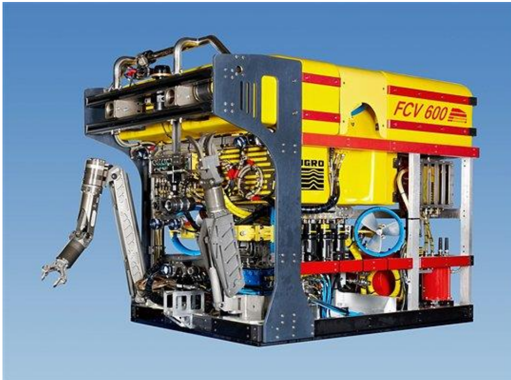
Slika 2-3. Podvodno plovilo s daljinskim upravljanjem kompanije Fugro Subsea Services Ltd. (Subsea World News, 2016)
