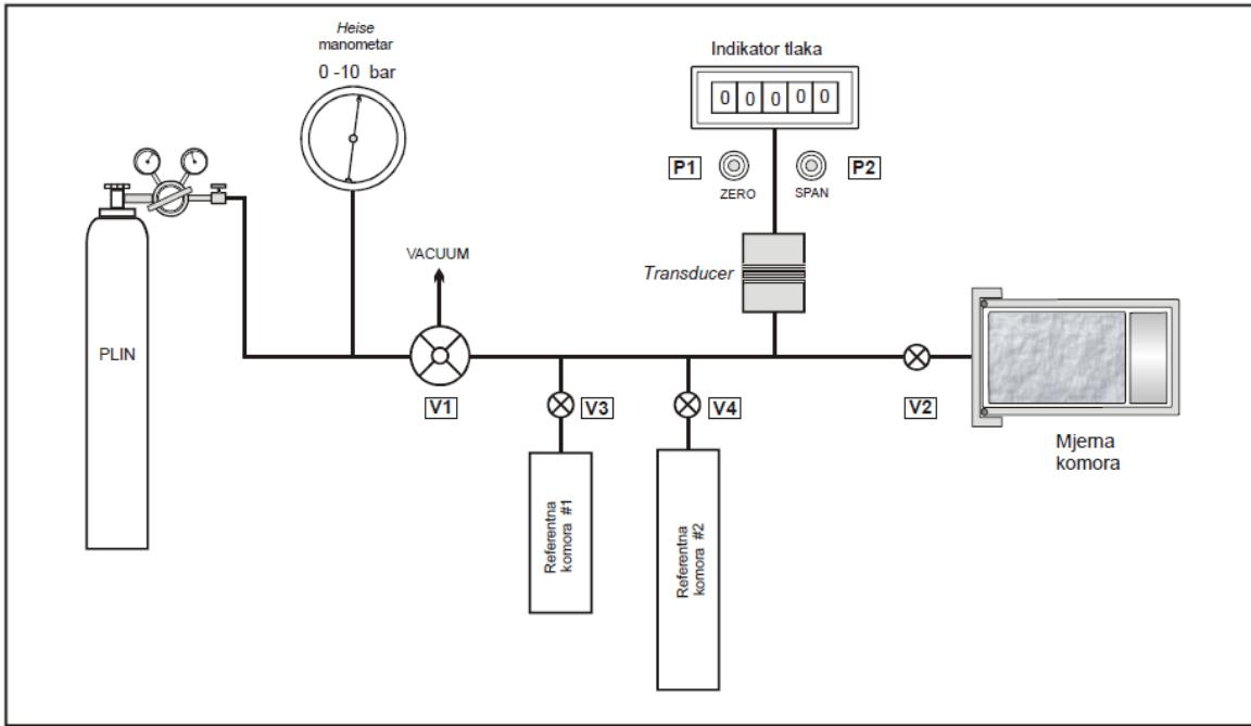
*Slika 4.2: Shema mjernog uređaja za mjerjenje poroznosti helijskom porozimetrijom (Vulin, 2017).*
