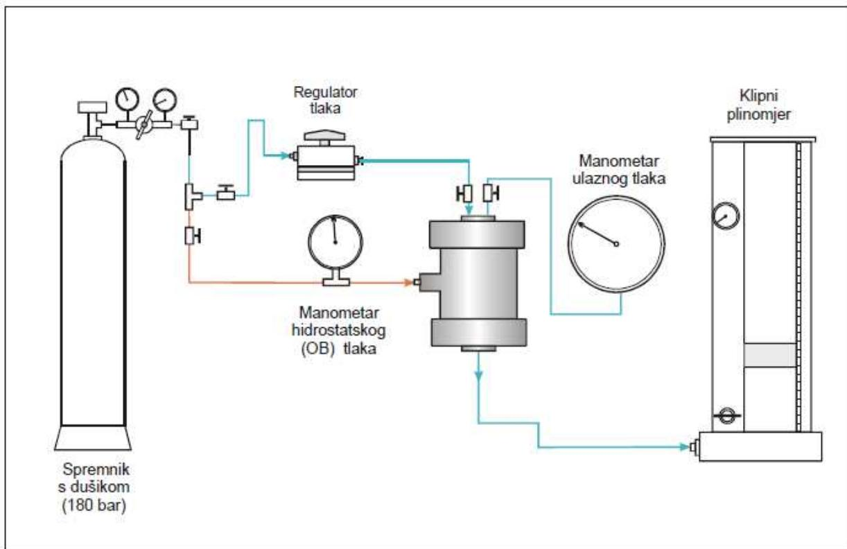
*Slika 4.3: Shema uređaja za mjerenje propusnosti protokom plina
