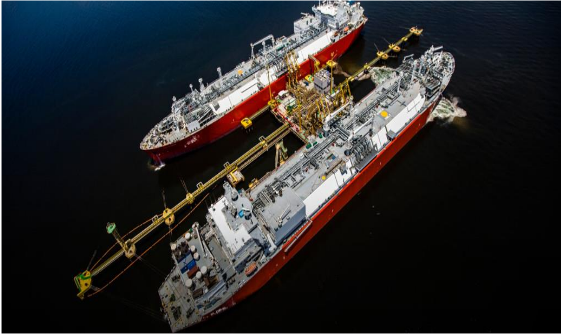
Slika 2-3. Sidrenje FSRU na gatu u sustavu brod-gat-brod (www.excelerateenergy.com, 2016)
