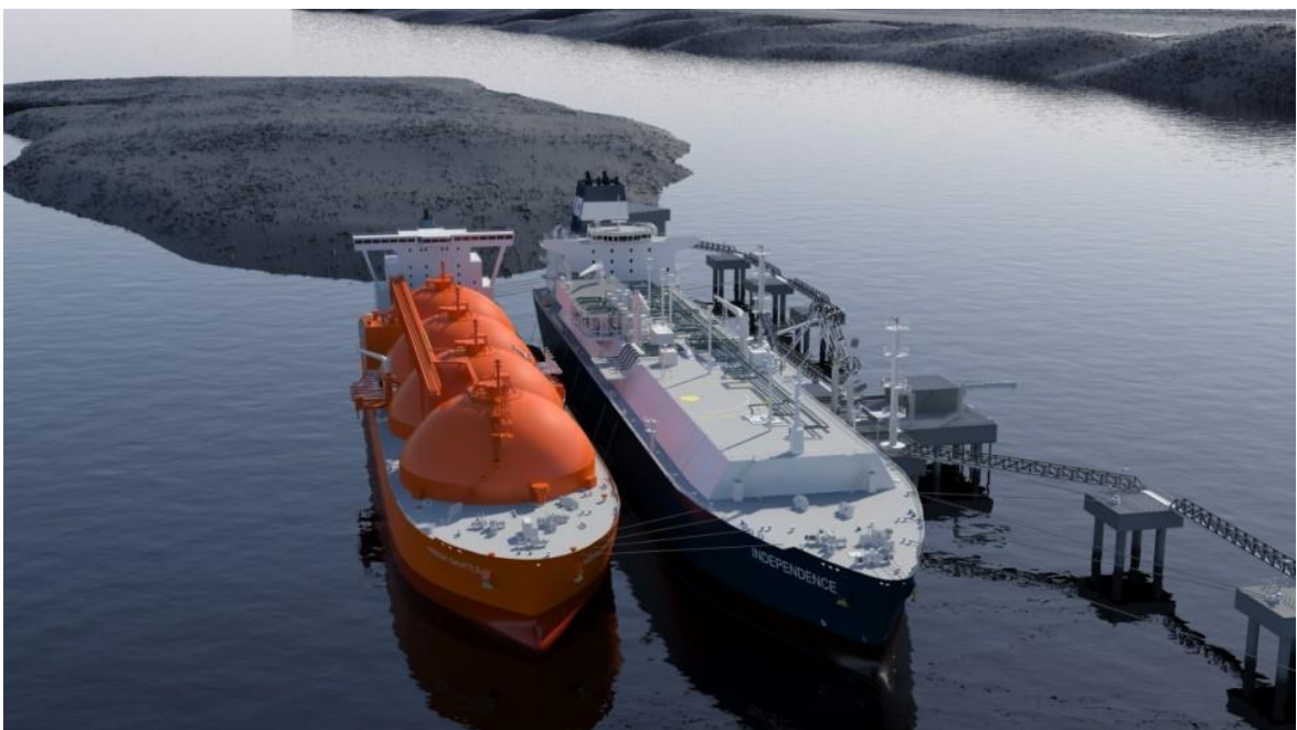
Slika 2-2. Sidrenje FSRU na gatuu sustavu brod-brod (www.lngworldnews.com, 2014)
