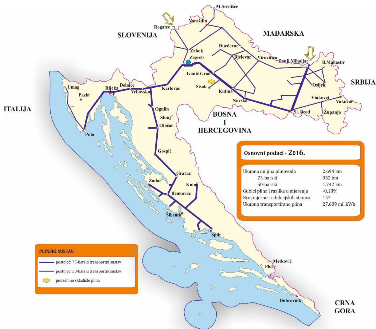
Slika 2-2. Plinski transportni sustav Republike Hrvatske (Hera, 2017a)
