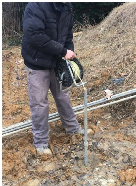
Slika 3.3 Mjerenje razine podzemne vode u bušotini B-3.
