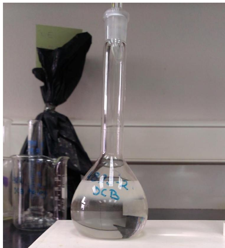
**Slika 3.6.** Voluminozni talog u volumetrijskoj tikvici.
