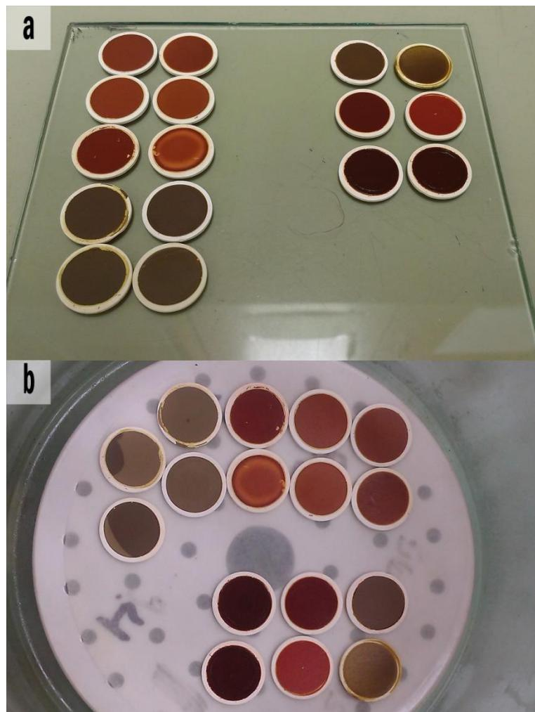
**Slika 3.15. (a)** Pločice s orijentiranim preparatima posložene po brojevima (4820-4861), nedostaje uzorak 4827. Uzorci s magnezijem su s lijeve strane, a uzorci s kalijem s desne strane.; **(b)** Pločice s orijentiranim preparatima u eksikatoru s etilen-glikolom.
