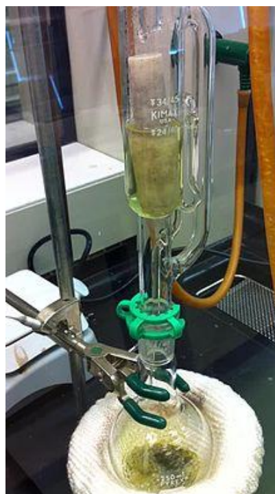
Slika 4-8. Soxhlet-ov ekstraktor s prikazom kruženja otapala (www.wikipedia.com, 2017)
