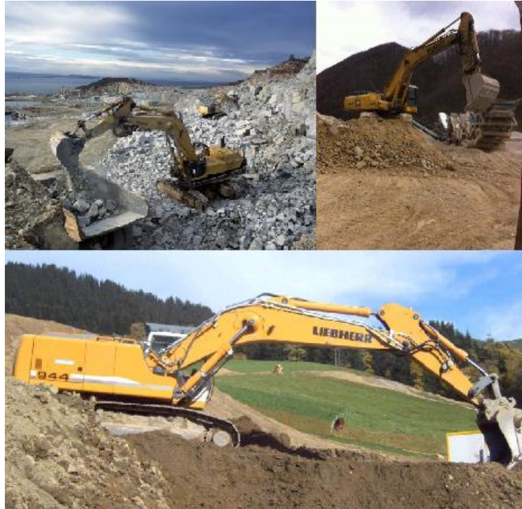
Slika 2-3. Različite primjene bagera; utovar u transportno sredstvo (gore lijevo), doziranje drobilice (gore desno), skidanje otkrivke (dolje)
