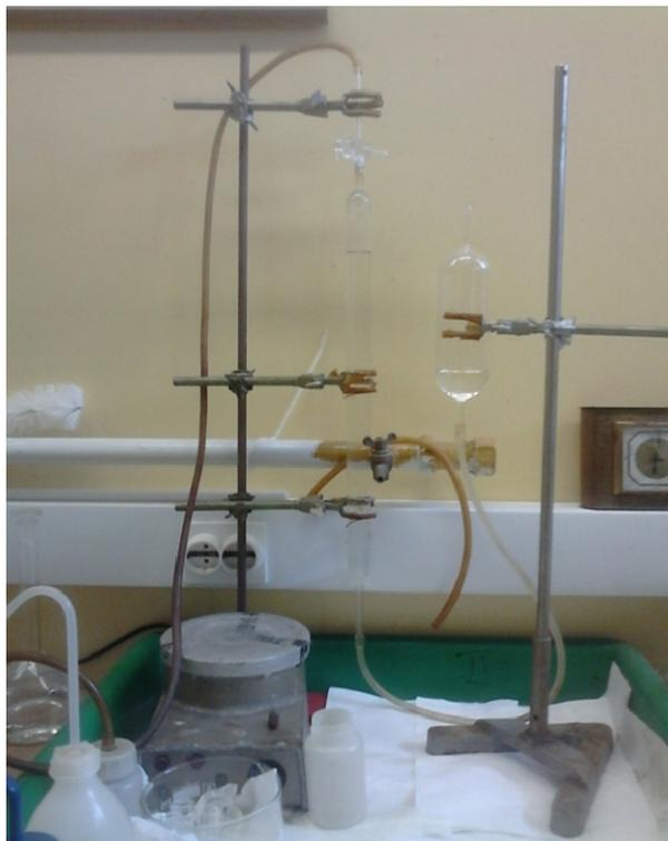
Slika 2-2. Scheiblerova aparatura.
