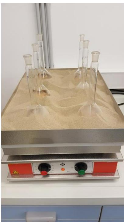
Slika 3-2. Piknometri u pješčanoj kupelji
