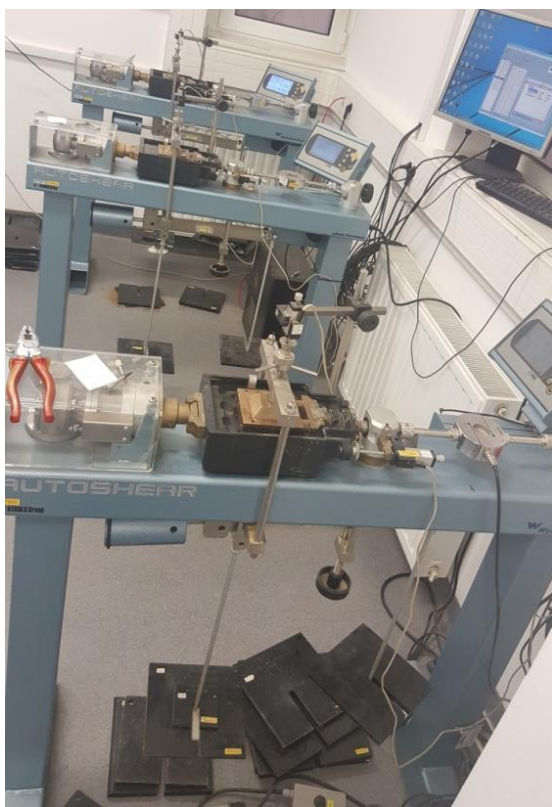
Slika 4-1. Tri uređaja za izravni posmik u Laboratoriju 2
