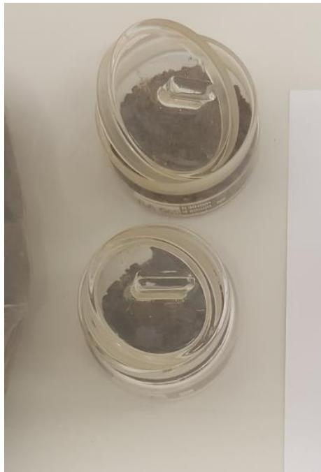
Slika 3-13. Posudica s uzorkom za određivanje vlažnosti
