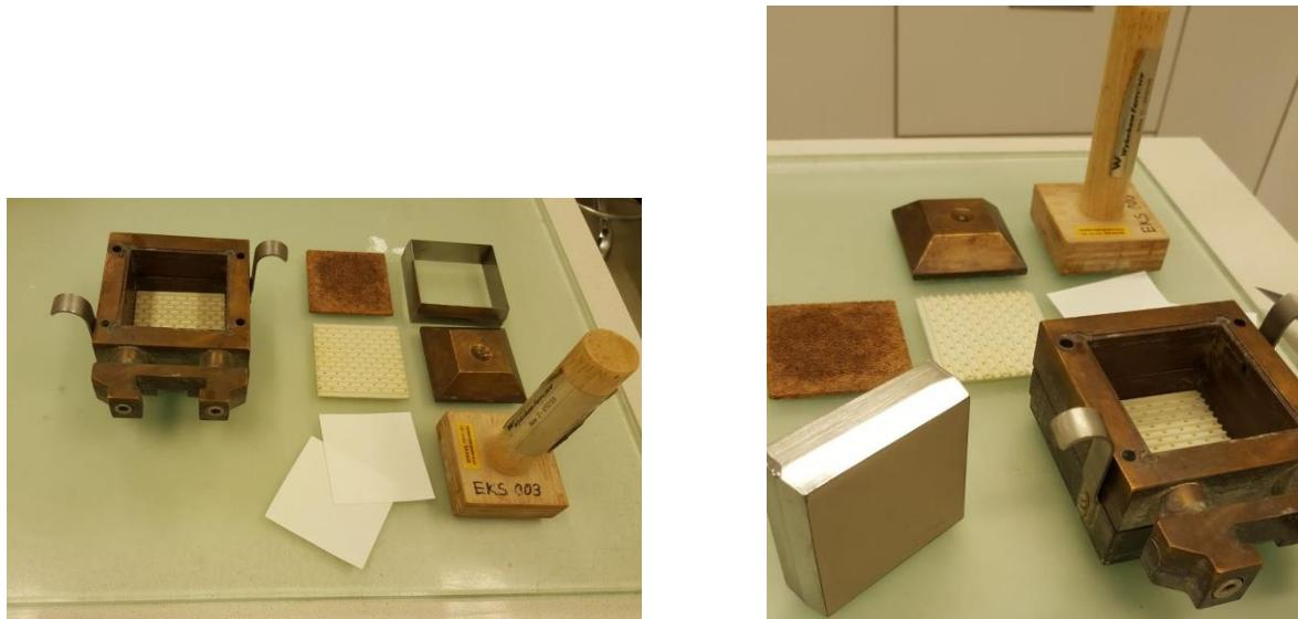
Slika 3-21. (a) Potreban pribor prilikom ugradnje, (b) Uzorak ugrađen u prsten
