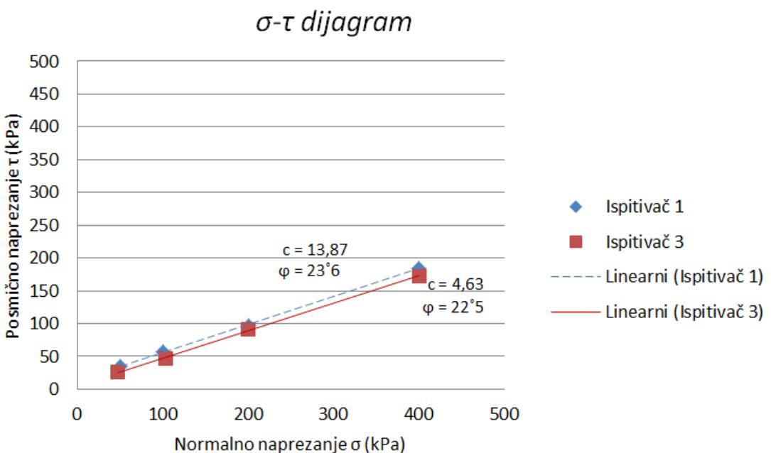
Slika 4-6. Usporedba rezultata između Ispitivača 1 i Ispitivača 3.
