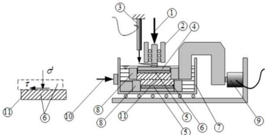
Slika 3-19. Dijelovi uređaja za izravni posmik
