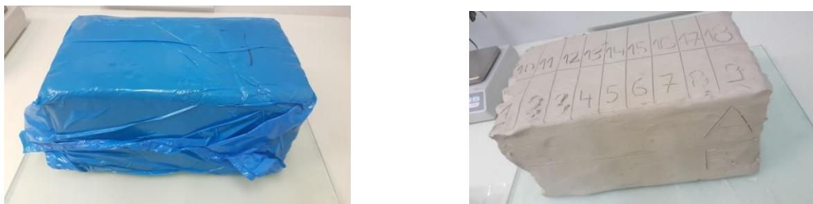
Slika 3-20.(a) Uzorak modelarske gline proizveden za komercijalnu upotrebu, (b) Podjela uzorka
