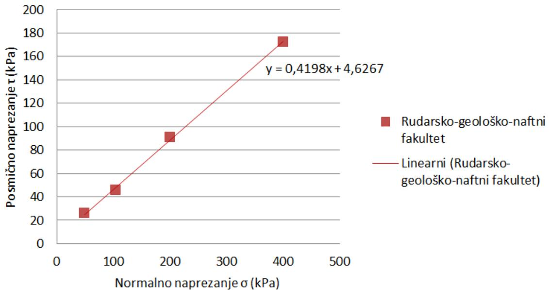
Slika 4-4. Prikaz rezultata ispitivanja izravnog posmika od ispitivača 3 u Laboratoriju 1.
