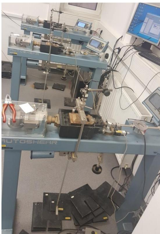
Slika 4-1. Tri uređaja za izravni posmik u Laboratoriju 2
