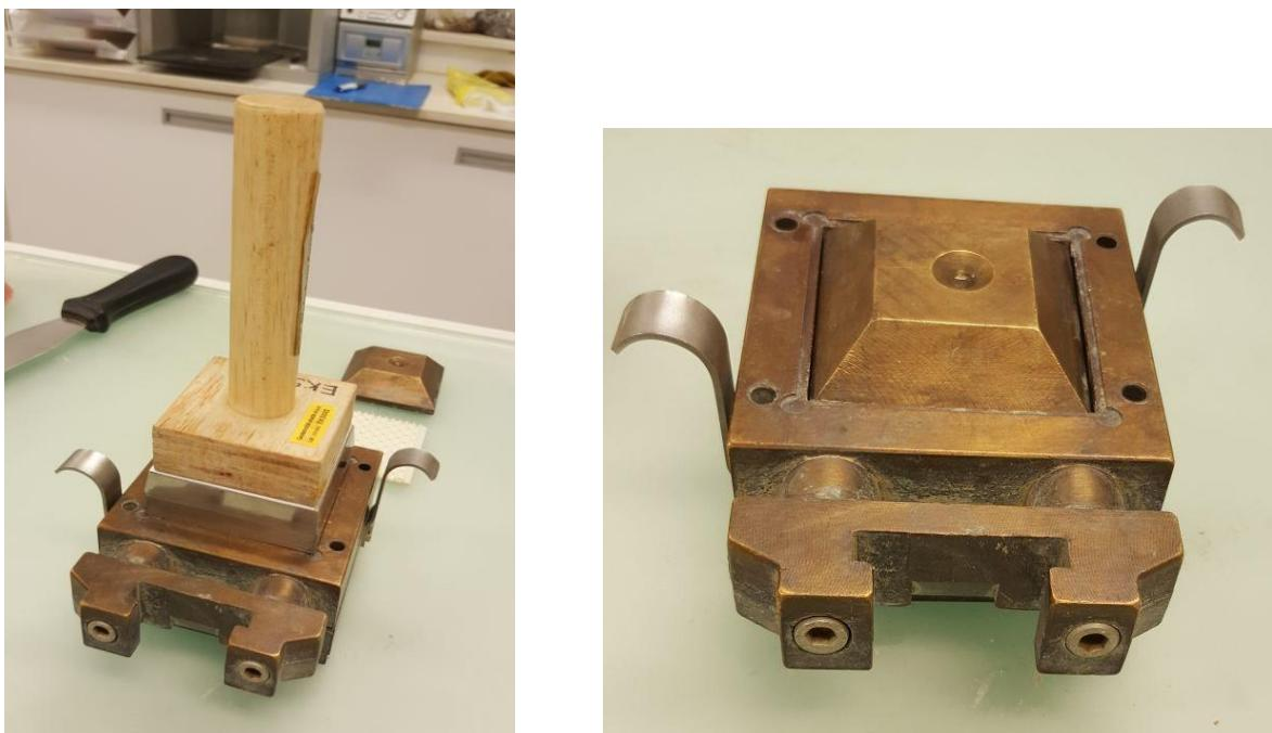
Slika 3-22. (a) Utiskivanje uzorka u kalup, (b) Ugrađen uzorak u kalup
