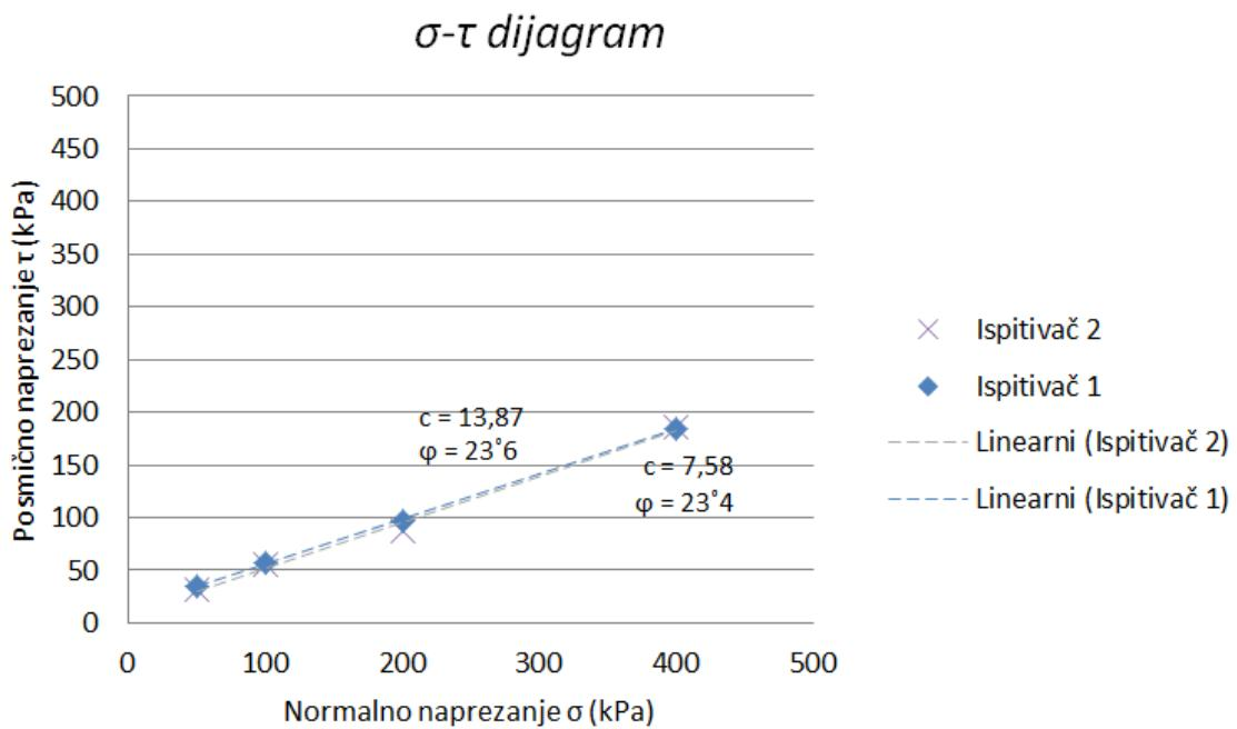
Slika 4-5. Usporedba rezultata između Ispitivača 1 i Ispitivača 2.
