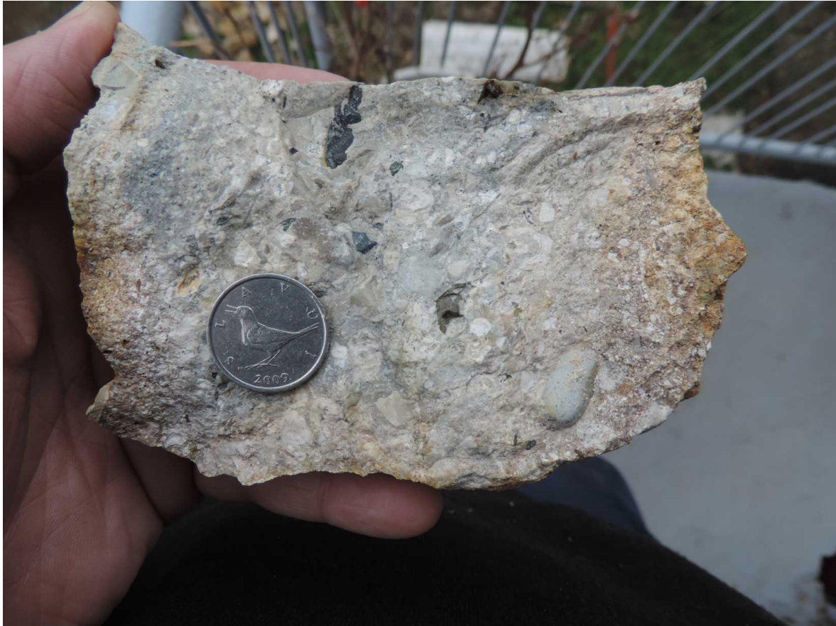
Slika 6.4. Valutice u prijelaznoj zoni odnosno u vrhu konglomerata. Vidljive su valutice sivog vapnenca, dijabaza i crnog vapnenca.
