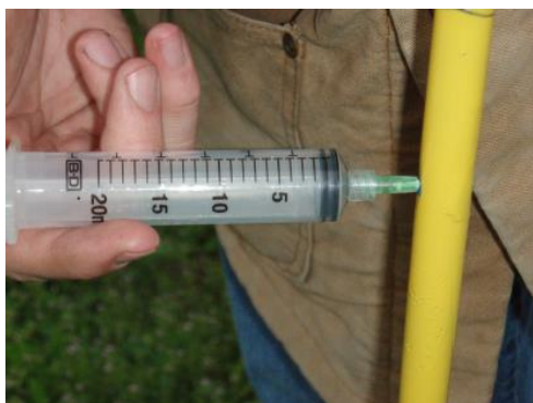
Slika 5.2: Prikaz injekcije za uzimanje uzorka i septum rupice (GeoFrontiers, 2018)
