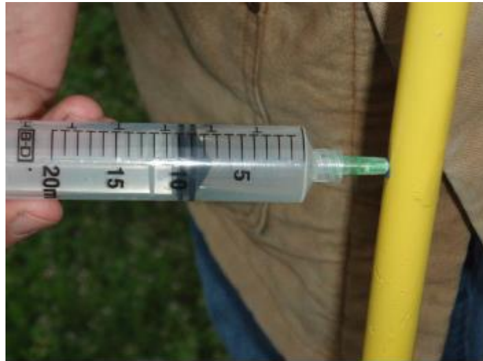
Slika 5.3. Primjer provjere tlaka u sondi (GeoFrontiers, 2018)
