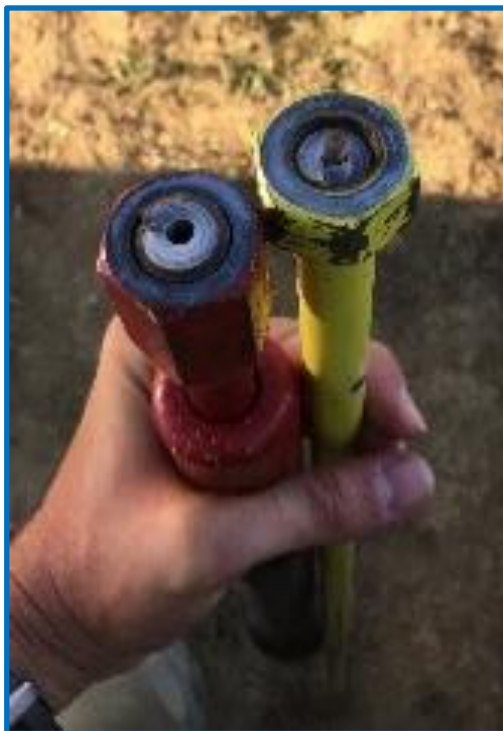
Slika 5.6: Prikaz puknuća sonde na terenu
