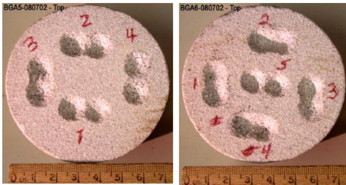
Slika 6-10. Uzorci BG-A5 I BG-A6. Ispitivanje broj 3 pokazalo je da razmak od 1,1 cm može ukloniti grube rubove između točaka (engl. ridge ) (Reed et al., 2003)
