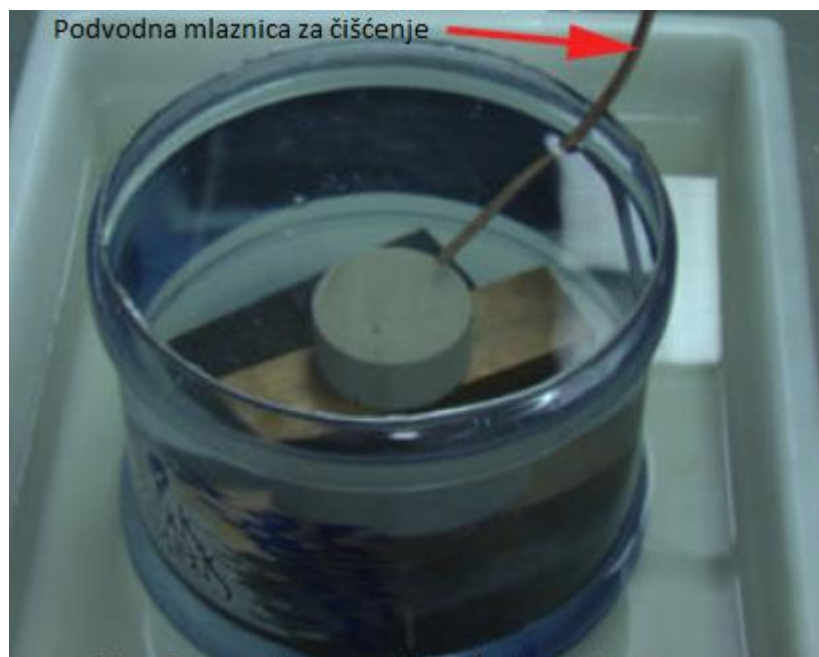
Slika 5-2. Stakleni bazen s vodenom mlaznicom (Reed et al., 2003)
