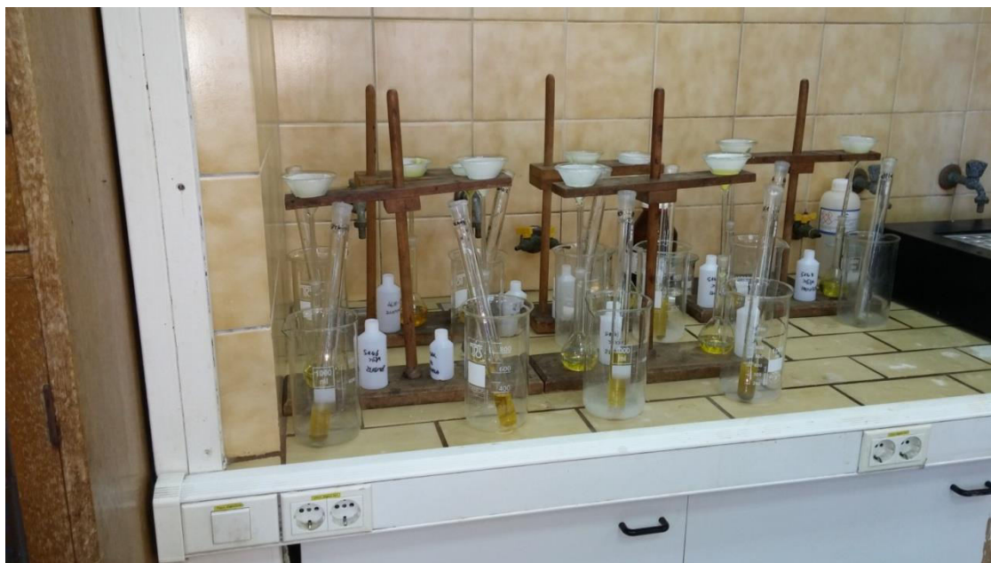
Slika 5-8. Slika prikazuje uzorke stavljene u reakcijsku epruvetu sa zlatotopkom
