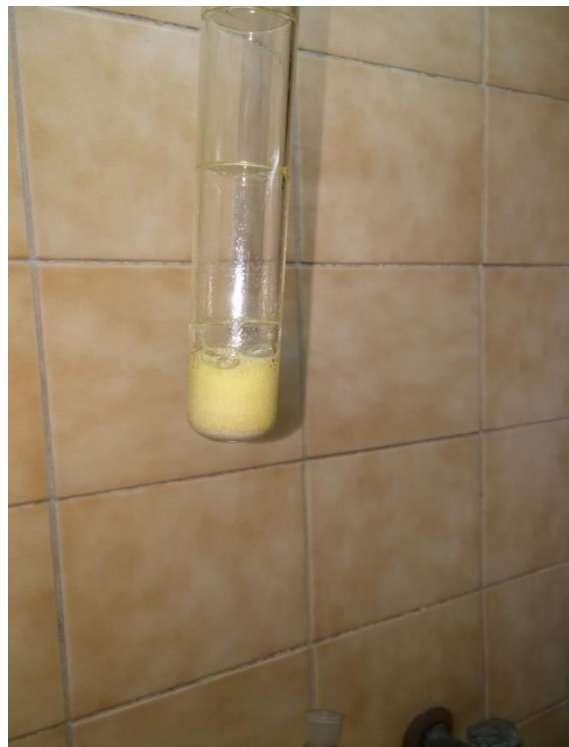
Slika 5-10. Burna reakcija uzorka sa zlatotopkom
