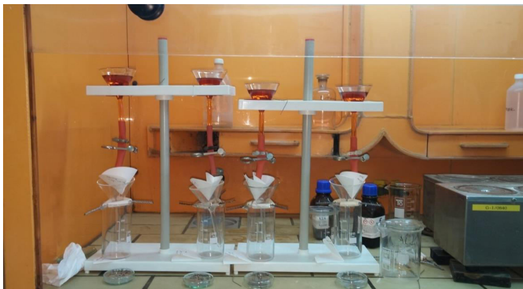
Slika 5-7. Separacija mineralnih frakcija bromoformom u digestijskom bloku
