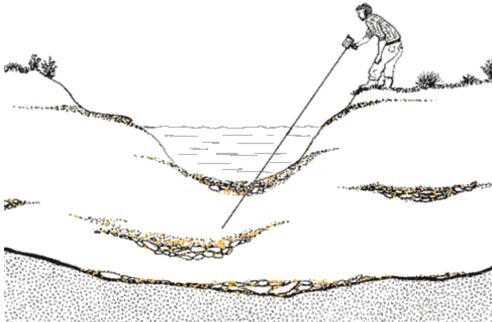
Slika 5-1. Princip uzorkovanja Goldspear instrumentom ( http://www.metalldetektor.se/gsmethod.htm )
