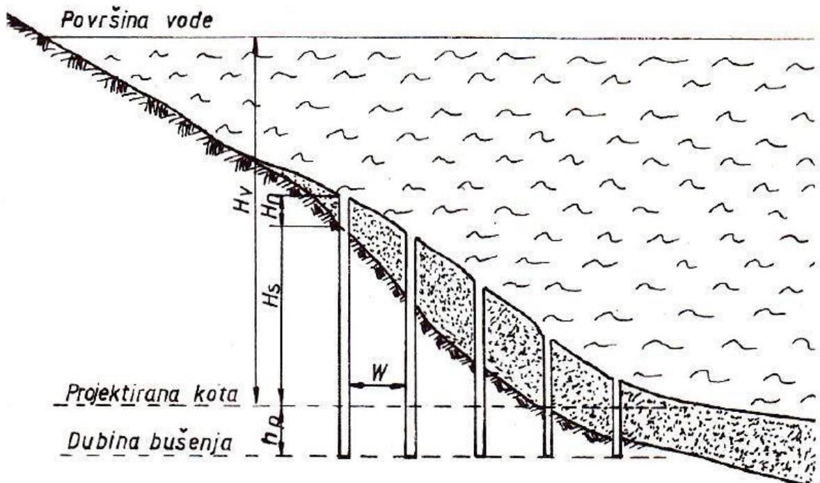
Slika 2-3. – Poprečni presjek podvodnog iskopa (Krsnik, 1989)
