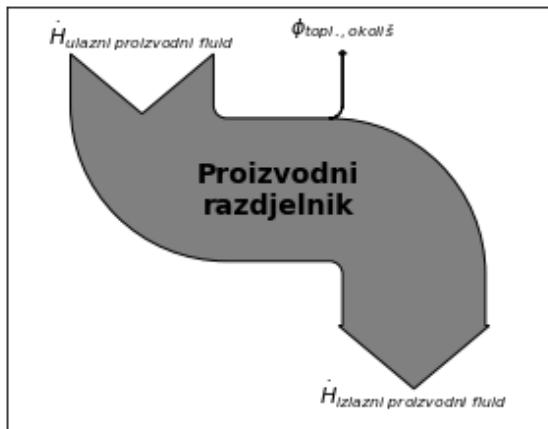
Slika 3-5. Prikaz energetske bilance podsustava proizvodnog razdjelnika
