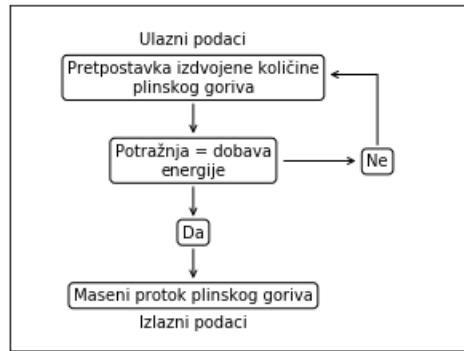
Slika 3-2. Prikaz algoritma modeliranja izdvojene količine plinskog goriva
