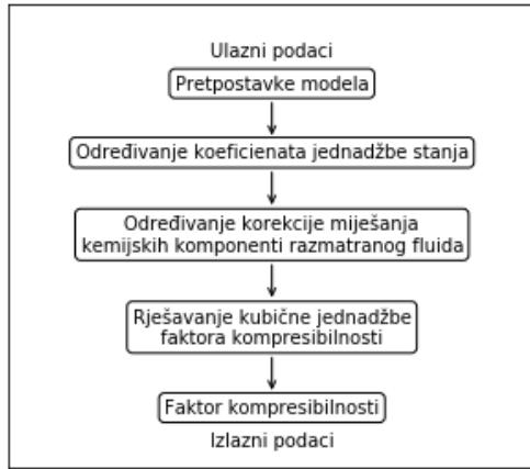
Slika 2-2. Prikaz algoritma postupka izračuna jednadžbe stanja za jednu točku sustava
