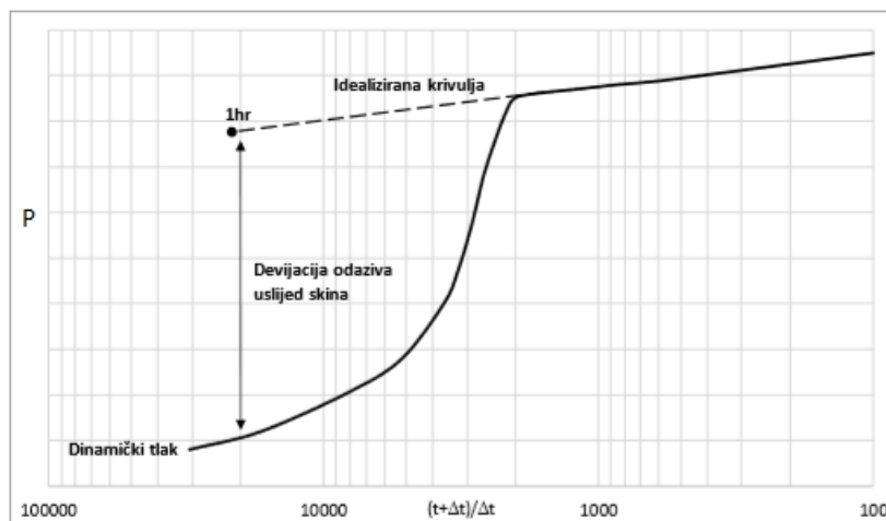
Slika 5-6. Ponašanje tlaka za vrijeme hidrodinamičkih testova u naftnom inženjerstvu a) protočni test, b) test porasta tlaka
