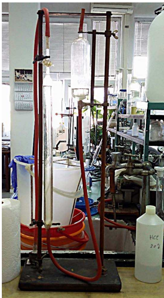
Slika 3.5. Aparatura korištena za određivanje udjela CaCO 3 po metodi kalcimetrije.
