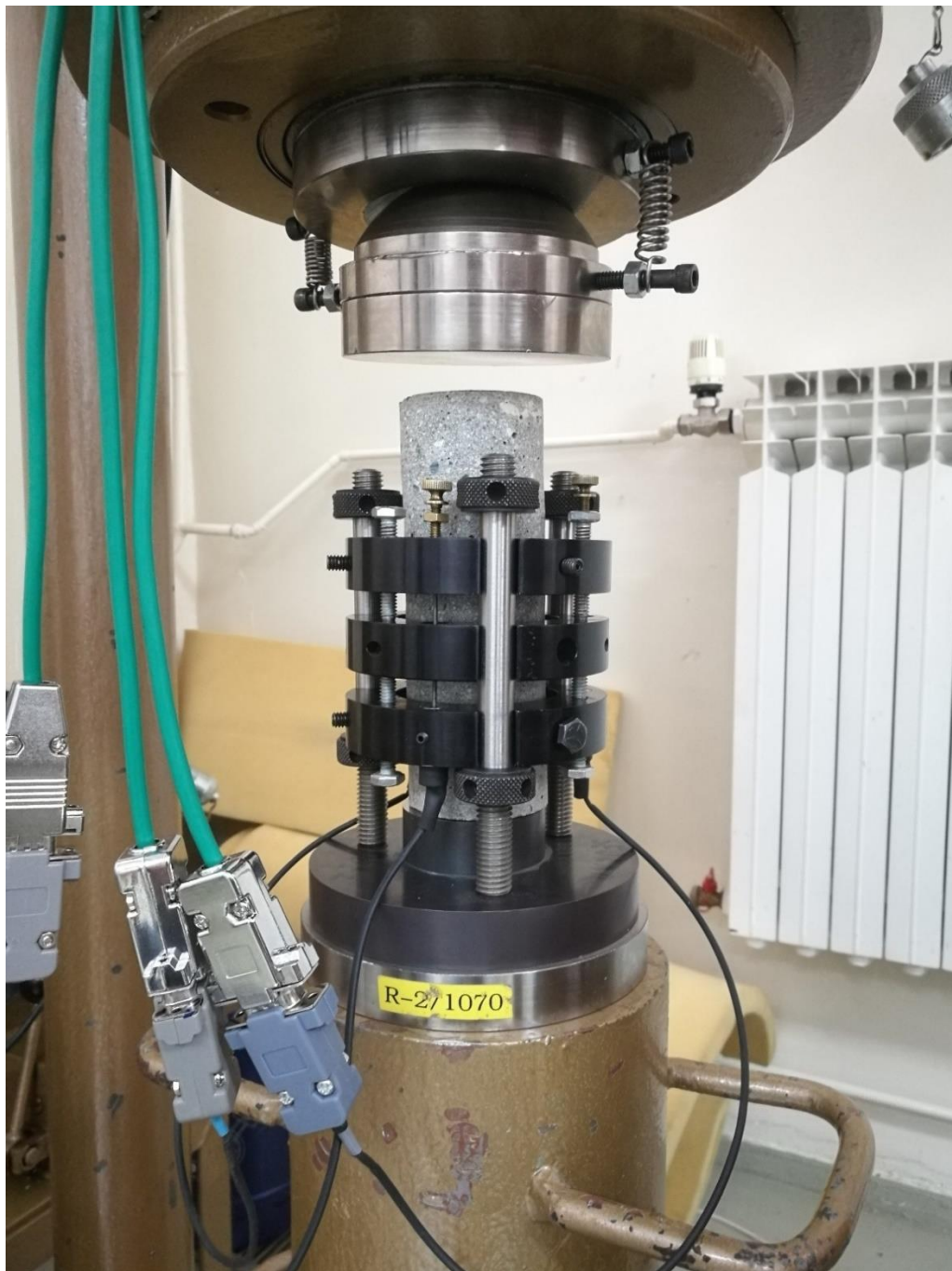
Slika 6-3. Ugrađeni uzorak spreman za ispitivanje
