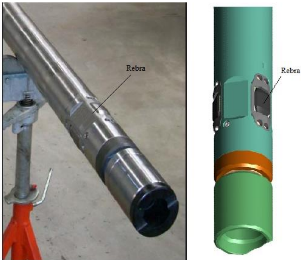
Slika 4-9. Stvarni i shematski prikaz rebara RSM sklopa (Ross et al., 2012)
