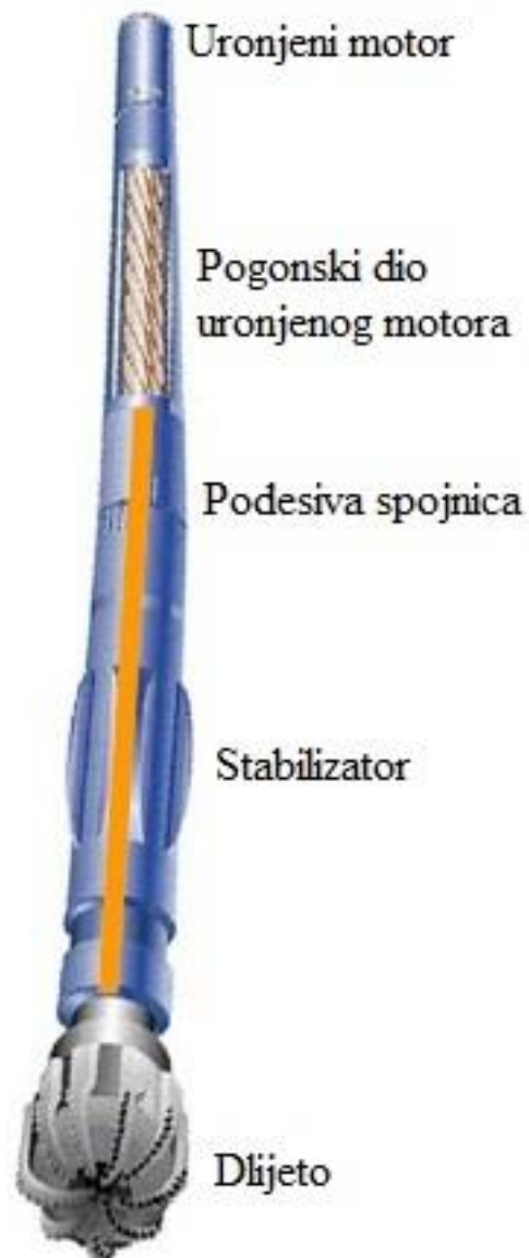
Slika 2-1. Primjer upravljivog sustava (Gaurina-Međimurec, 2015)
