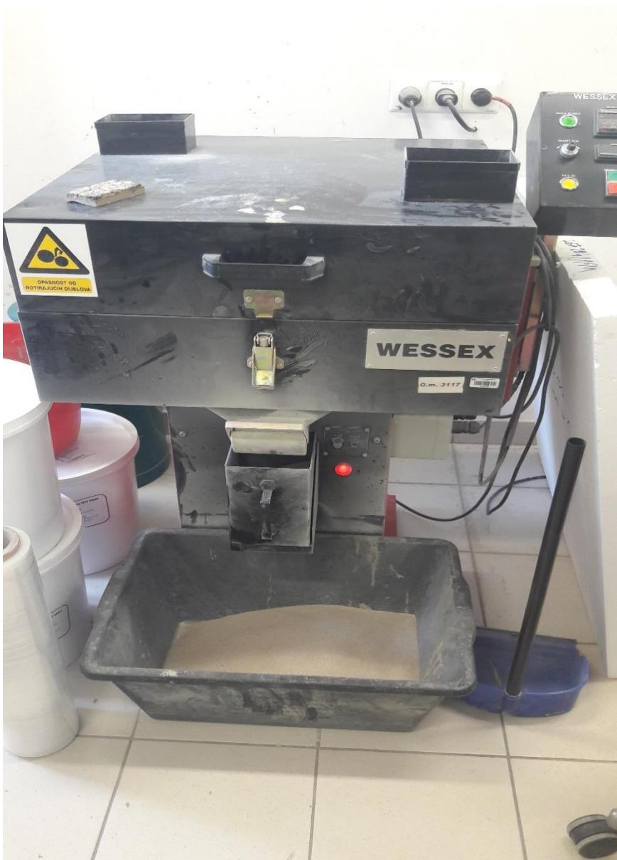
Slika 4-9 Uredaj za ispitivanje otpornosti na abraziju
