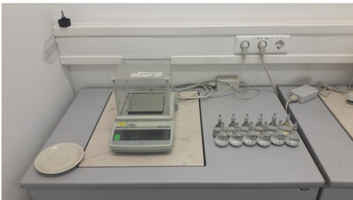
Slika 4-23 Piknometri popunjeni s vodom
