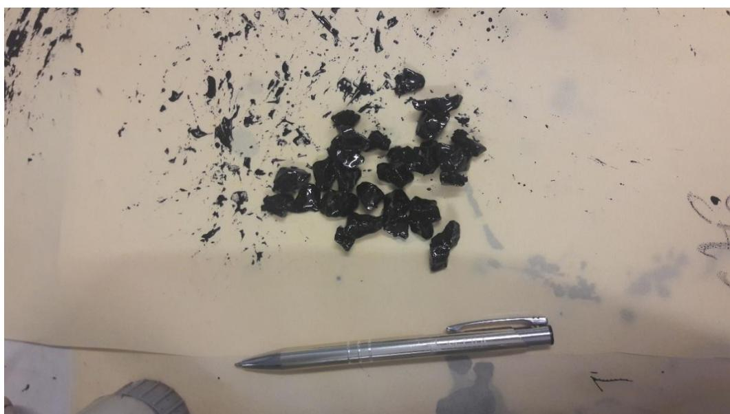
Slika 4-18 Agregat potpuno pomiješan s bitumenom
