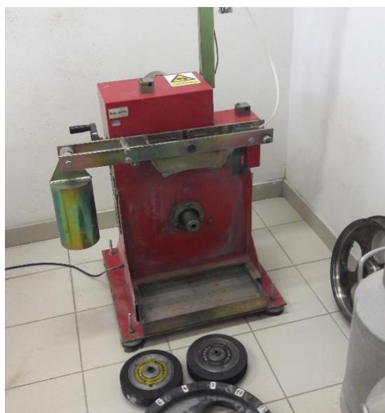
Slika 4-13 Uredaj za ispitivanje otpornosti na polirnost
