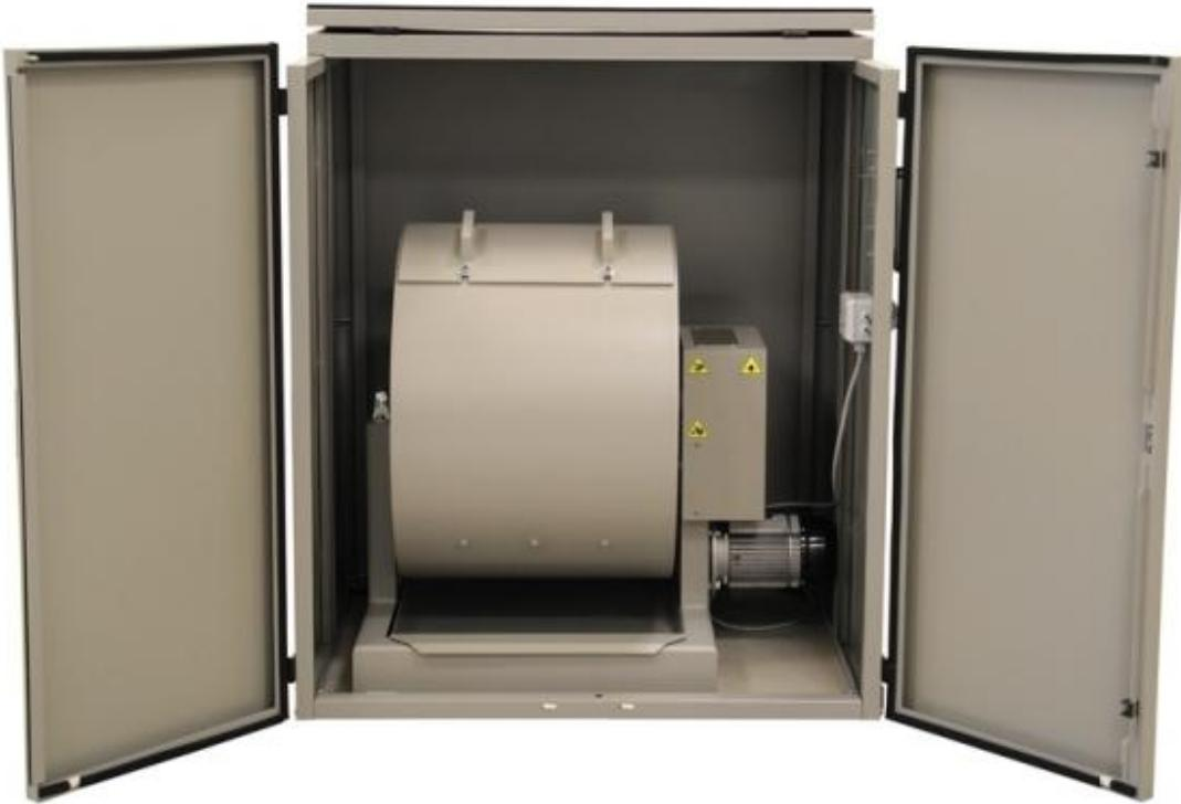
Slika 4-4 Uredaj za ispitivanje agregata na otpornost (LA)
