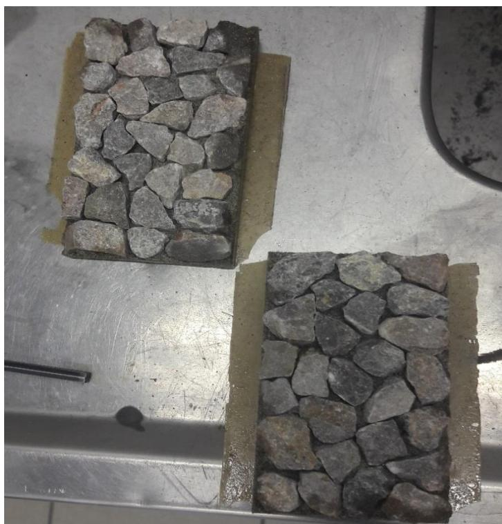
Slika 4-8 Pripremljeni uzorci za abraziju
