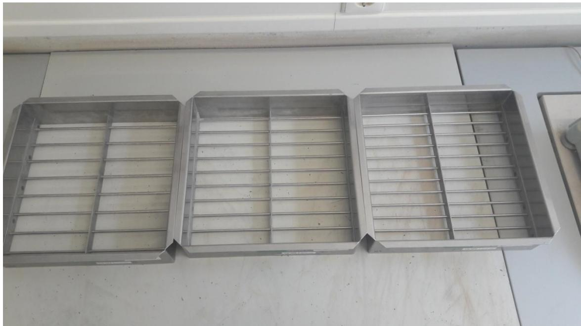
Slika 4-3 Rešetke za određivanje plosnatosti zrna
