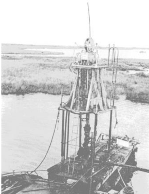
Slika 1-1. Injektorski sklop prvog funkcionalnog postrojenja za rad sa savitljivim tubingom (Petrowiki, 2018a)
