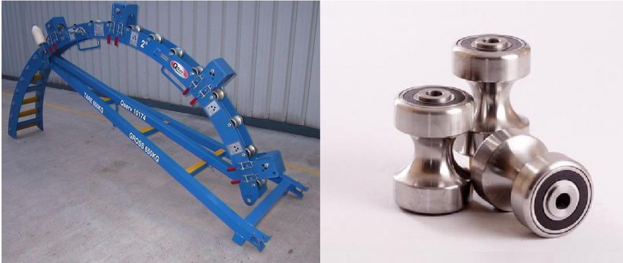
Slika 3-12. Vodicica savitljivog tubinga i pripadajući valjci (Rigarena, 2018)
